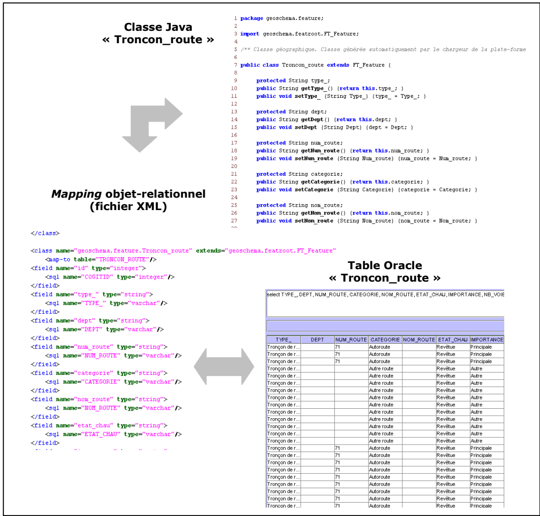
Figure 90. Les correspondances entre les tables ORACLE dans lesquelles sont stockées les données et les classes JAVA correspondantes sont déclarées dans une série de fichiers XML, gérés par OJB. (D'après [Badard et Braun 2003])
