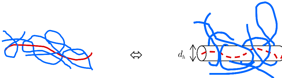
Schéma I-3 Représentation simpliste de la notion de tube (chaîne linéaire au sein d'un réseau enchevêtré)
