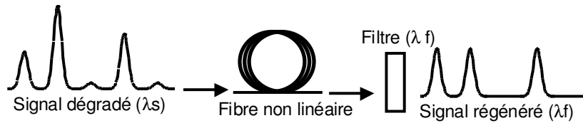
Figure II.13 : Schéma d'un régénérateur par filtrage décalé.
