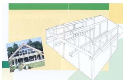
Ce type de structure réclame un examen attentif du mode de contreventement selon des plans longitudinaux, transversaux et en plan. La connaissance des détails d'assemblage
