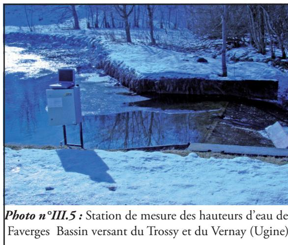
**Photo n°III.5 :** Station de mesure des hauteurs d'eau des Faverges Bassin versant du Trossy et du Vernay (Ugine)
