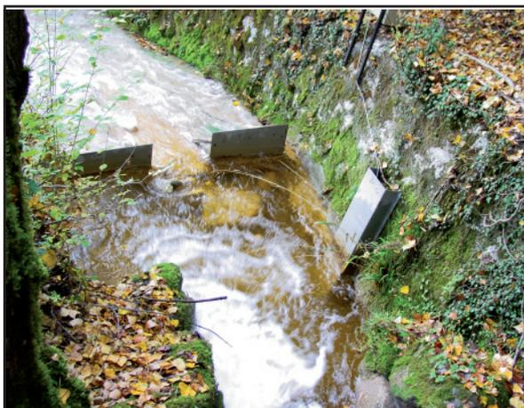
**Photo n°III.4 :** Station de mesure des hauteurs d'eau des Combes – Bassin versant des Combes
