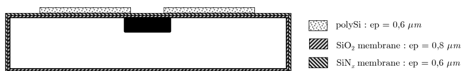
Figure 3.32 : Elimination du polySi les faces latérales et inférieure.
