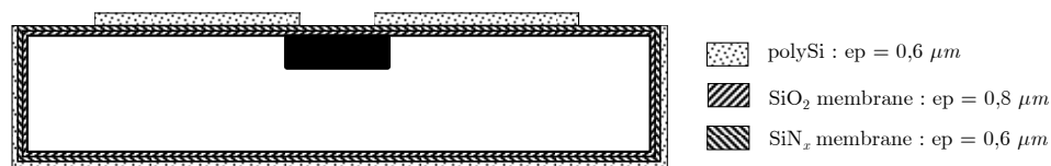
Figure 3.30 : Réalisation des bras en silicium polycristallin.
