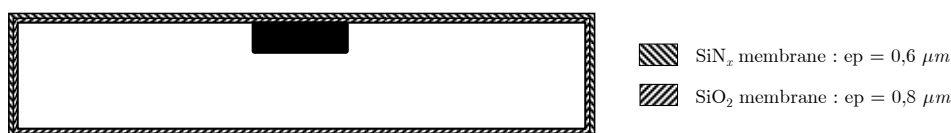
Figure 3.27 : Dépôt de la couche \text{SiO}_2/\text{SiN}_x .
