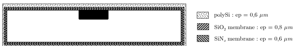
Figure 3.28 : Dépôt du silicium polycristallin.
