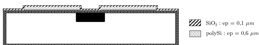
Figure 3.33 : Dépôt de la couche d'oxydation dédié à l'isolation électrique des thermocouples.
