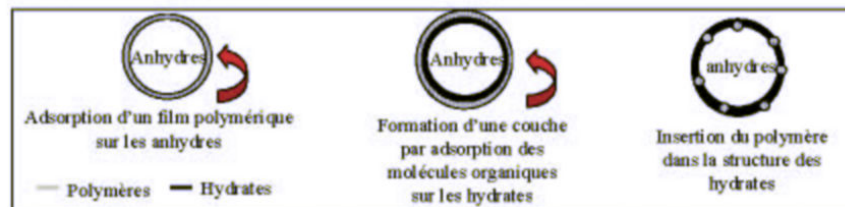
figure 111. Mécanismes possibles d'interaction entre le ciment et les adjuvants organiques
