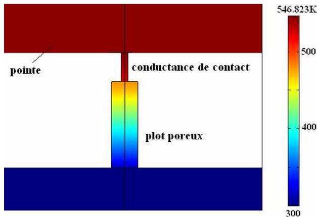
Figure III-25 : Echauffement d'un plot de silicium poreux unique ( $k=0.16\text{W}\cdot\text{m}^{-1}\cdot\text{K}^{-1}$ ) par contact avec une pointe chauffante dans laquelle une puissance de 12mW a été injectée.
