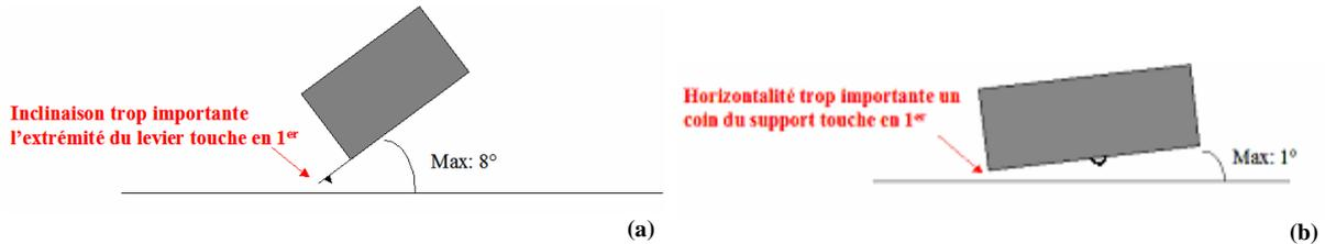
Figure V-20 : Schémas de principe du réglage des angles d'inclinaison et d'horizontalité des pointes IBM par rapport à la surface : (a) Vue de côté : l'inclinaison par rapport à la surface doit être au maximum de 8° pour éviter que l'extrémité du levier ne touche, (b) Vue de face : l'angle par rapport à l'horizontale doit être au maximum de 1° pour éviter qu'un bord du support ne touche.
