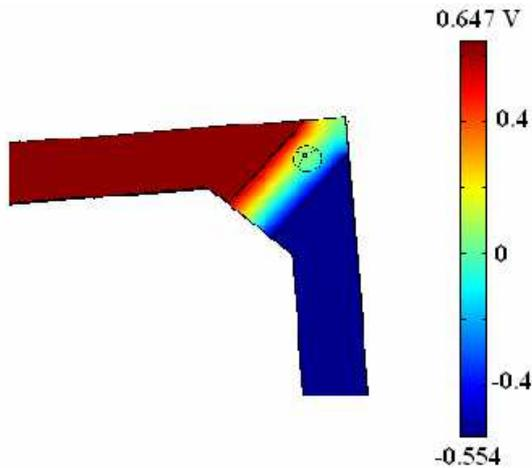
Figure III-13 : Distribution de potentiel électrique dans un levier en silicium de résistivité 0.05 Ω.cm, lorsqu'un courant de 10 mA est injecté dans les contacts métalliques
