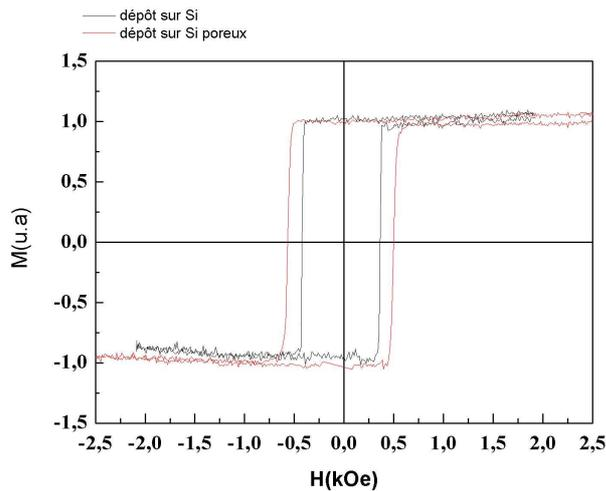
Figure IV-15 : Cycles d'hystérésis mesurés par effet Kerr polaire sur des multicouches  $Pt_{10nm}/(Co_{0.6nm}/Pt_{1.8nm})_4$  déposées sur des couches poreuses de  $5\ \mu m$  d'épaisseur et 70% de porosité (courbe rouge) et sur silicium (courbe noire).
