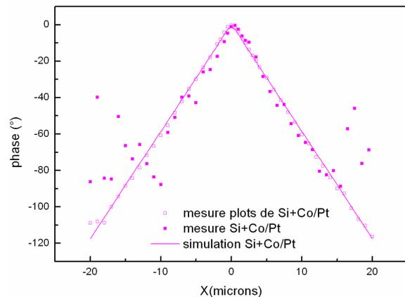
Figure IV-41 : Courbes de phase mesurées en thermoréflectance à 300kHz sur un réseau de plots de silicium et un substrat continu de silicium recouverts de  $\text{Pt}_{10\text{nm}}/(\text{Co}_{0.6\text{nm}}/\text{Pt}_{1.8\text{nm}})_4$  et simulation effectuée en considérant une couche continue de silicium (trait plein).
