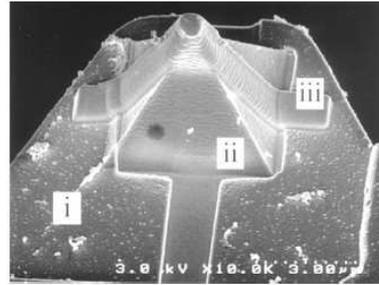
Figure V-2 : Image MEB d'une pointe thermorésistive : (i) Contacts en Aluminium, (ii) Pointe en nitrure de silicium, (iii) Ruban de Platine [139].
