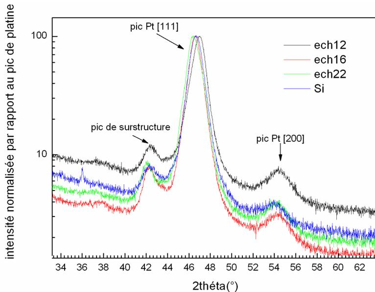
Figure IV-17 : Spectre de diffraction de multicouches  $\text{Pt}_{10\text{nm}}/(\text{Co}_{0.6\text{nm}}/\text{Pt}_{1.8\text{nm}})_4$  déposées sur  $10\mu\text{m}$  de silicium poreux (ech12 et ech16), sur  $5\mu\text{m}$  de silicium poreux (ech22) et sur silicium (courbe bleue) à l'aide d'un diffractomètre de poudre utilisant une source de rayons X de Cobalt de longueur d'onde  $0.179\text{nm}$  (échelle semi-logarithmique)
