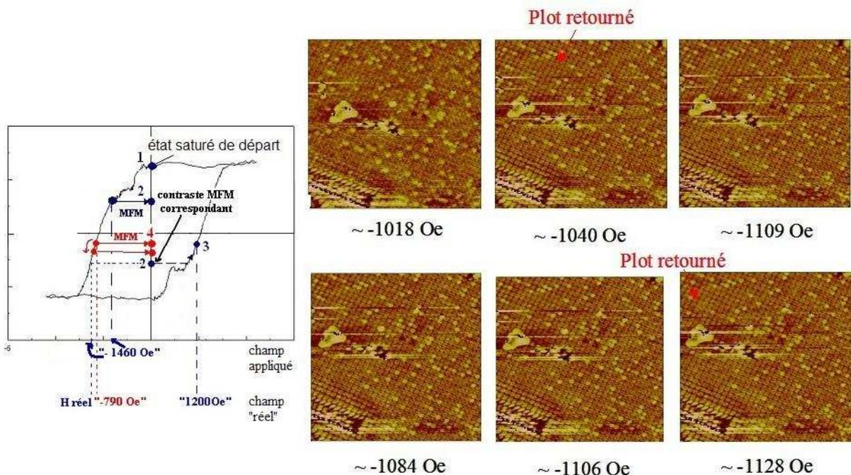
Figure VI-9 : A droite : images MFM effectuées après des pulses de champ de 100ms et d'intensités croissantes afin de retourner l'aimantation des plots jaunes. A gauche : histoire magnétique, suivie au cours de cette procédure, du réseau de plots, repérée sur le cycle d'hystérésis mesuré par effet Kerr
