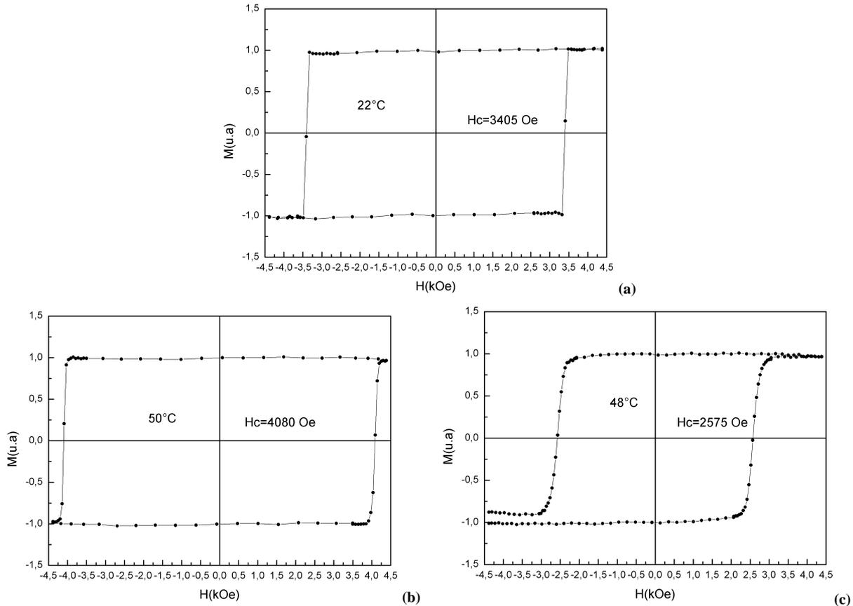
Figure IV-26 : Cycles d'hystérésis mesurés par effet Kerr polaire à température ambiante d'une couche  $Tb_{21.6}Fe_{65}Co_8Cr_{5.4}$  de 25nm d'épaisseur déposée sur un substrat de silicium (a), à 50°C de couches de 50nm d'épaisseur déposées sur un substrat de silicium (b), et sur une couche de silicium poreux de 5 $\mu$ m d'épaisseur (c) 8
