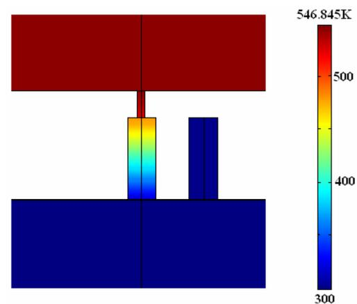
Figure III-26 : : Echauffement d'un plot de silicium poreux et de son voisin ( $k=0.16\text{W}\cdot\text{m}^{-1}\cdot\text{K}^{-1}$ ) lorsque ce premier est mis en contact avec une pointe chauffante dans laquelle une puissance de 12mW a été injectée.
