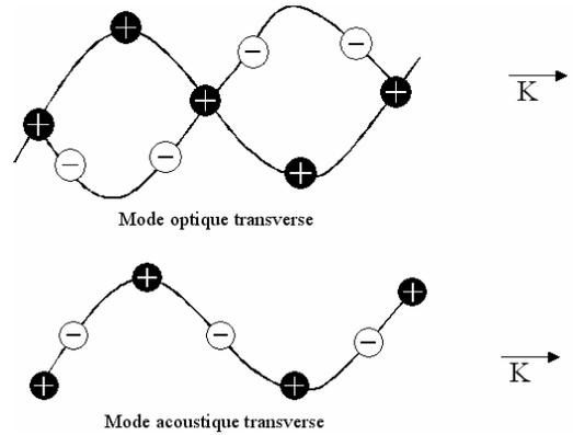
**Figure II-19 :** Ondes transverse optique et acoustique dans un réseau linéaire diatomique
