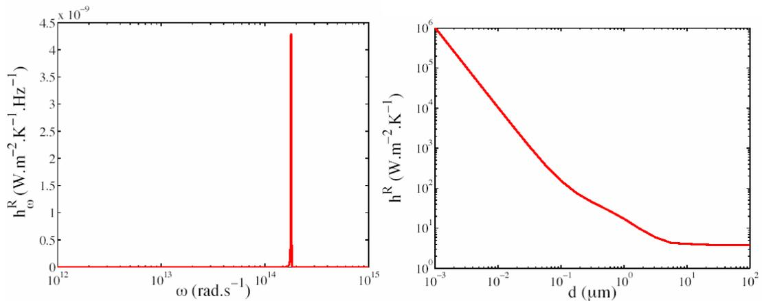
Figure II-14 : A gauche : le coefficient de transfert monochromatique à 300K entre deux milieux semi-infinis de SiC séparé par une distance  $d=10\text{nm}$ , en fonction de la pulsation de la radiation. A droite : le coefficient de transfert radiatif entre deux plans semi-infinis de SiC en fonction de la distance  $d$  de séparation. (échelle log-log) [64]
