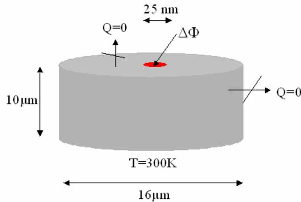
Figure III-3 : Géométrie utilisée pour les simulations thermiques
