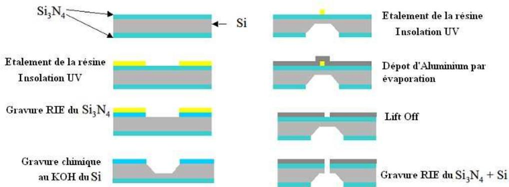
Figure V-8 : Procédé de fabrication des masques mécaniques.
