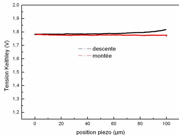
Figure V-22 : Evolution de la tension aux bornes d'une pointe IBM dans laquelle un courant de 0,65mA est injecté, loin de toute surface pendant un mouvement de descente et de montée à une vitesse de 500nm/s.
