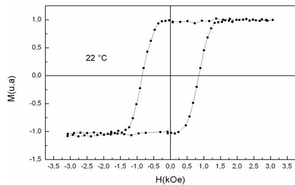
Figure IV-35 : Cycle d'hystérésis perpendiculaire au plan mesuré par effet Kerr polaire à température ambiante d'une couche de  $Tb_{21.6}Fe_{65}Co_8Cr_{5.4}$  de 50nm d'épaisseur déposée sur des plots en silicium poreux de 100nm de côté, de 300nm de haut et espacés de 100nm
