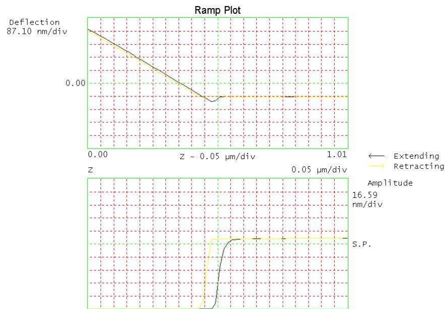
Figure VI-10 : Courbes de déflexion (en haut) et d'amplitude (en bas) en fonction de la hauteur du piézoélectrique
