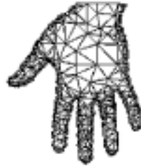
Figure III.16: Triangulation de Delaunay d'une main ([246]) : Il s'agit de générer sur chaque image une triangulation 2/3 (c'est à dire un assemblage de triangle 2D dans un espace euclidien \mathbb{R}^3 ) qui fait donc un pavage dense de l'image. Il suffit alors de reconstruire chaque petit plan facette, c'est à dire connaître les images de 3 points par une application (transformation affine donnée)
