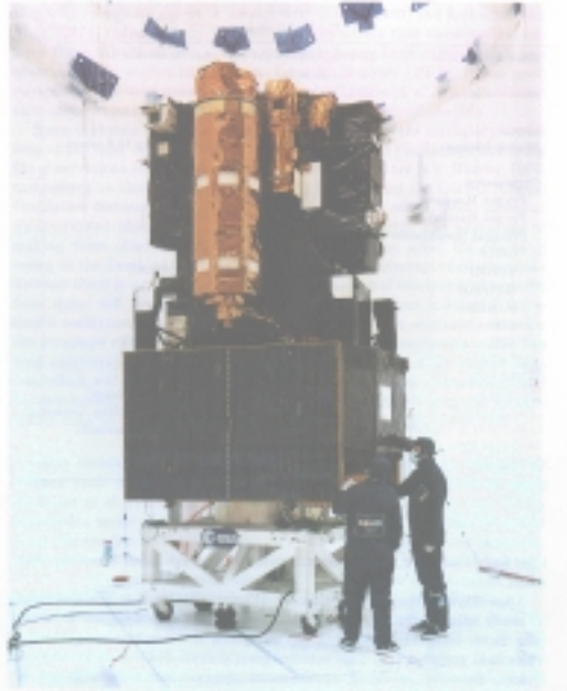
Figure II.7: Le satellite SOHO : au premier plan au centre l'instrument EIT
