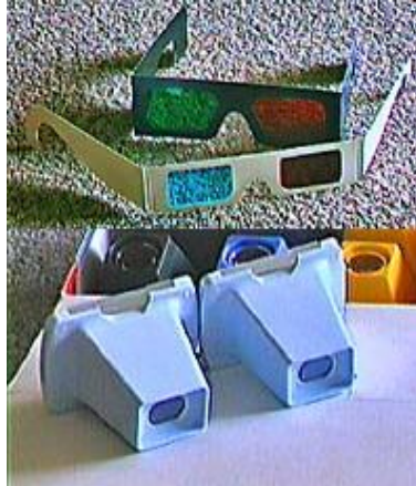
Figure III.11: 2 méthodes utilisées permettant une vision stéréoscopique: (a) en bas pour des diapositives, (b) en haut pour des anaglyphes
