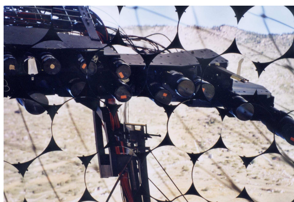
FIG. I.13 – Vue d'une partie de l'optique secondaire : miroirs secondaires réfléchissant les caméras situées à leur focale (on distingue plusieurs cônes de Winston collés à des photomultiplicateurs, protégés de jour par des caches, et la structure les contenant).
