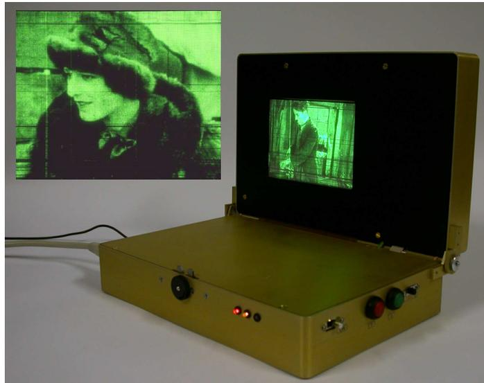
**Figure 1-1-3** Photographies de l'écran CNT-FED démontré par le Léti en 2004.
