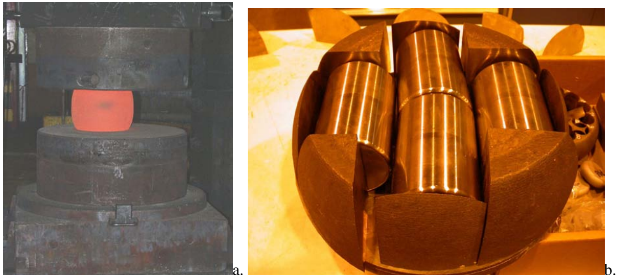
Figure V.10 : a. Forgeage d'un lopin sur la presse 4000t à Snecma Moteurs Gennevilliers b. Découpe de nouvelles pièces dans le lopin forgé
