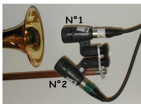
Figure 3.4: Placement des microphones au voisinage du pavillon de la trompette
