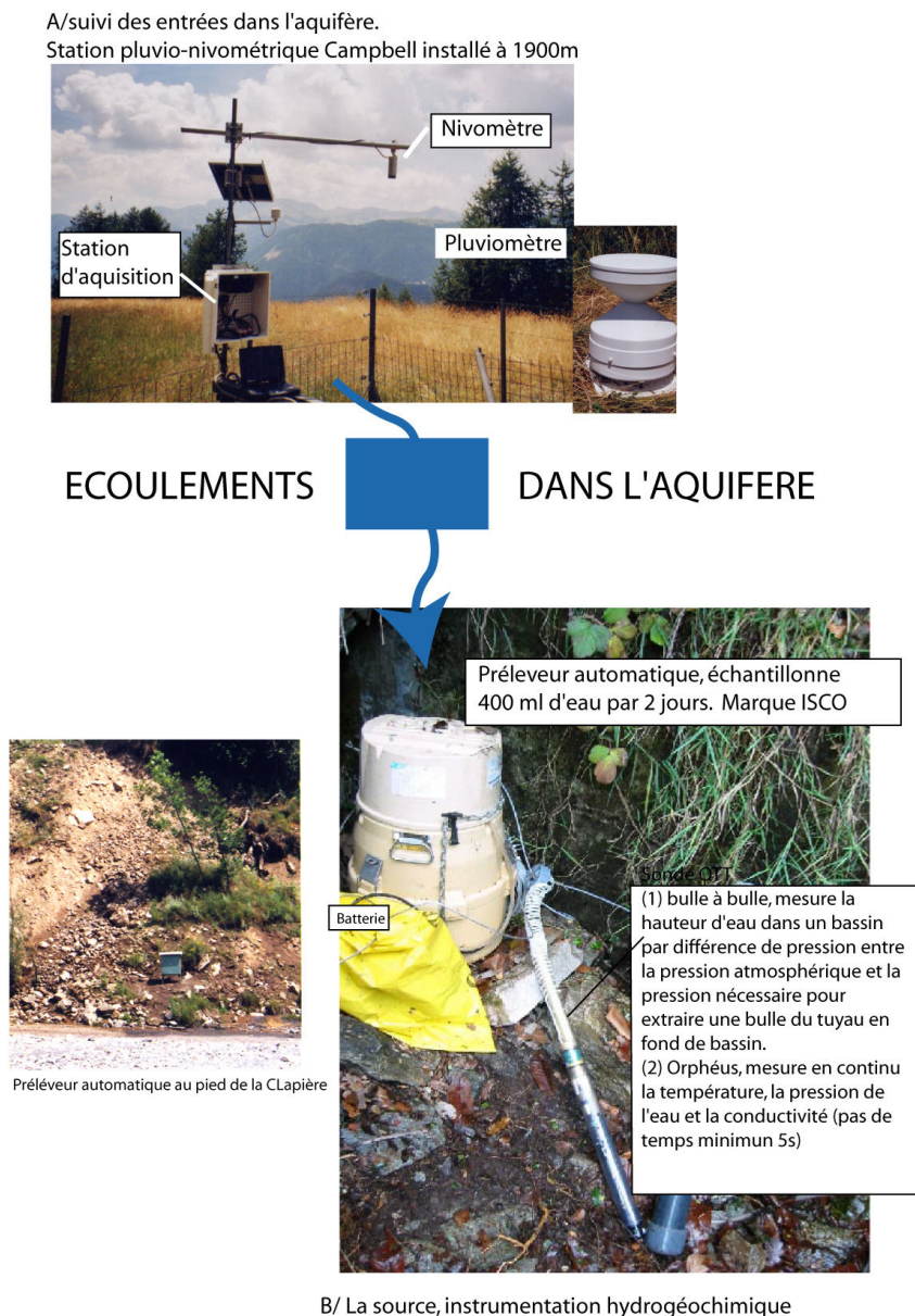
Fig.1. 19 : Matériel de terrain pour l'hydrogéochimie, A/ pluviométrique B/ instrumentation à la source
