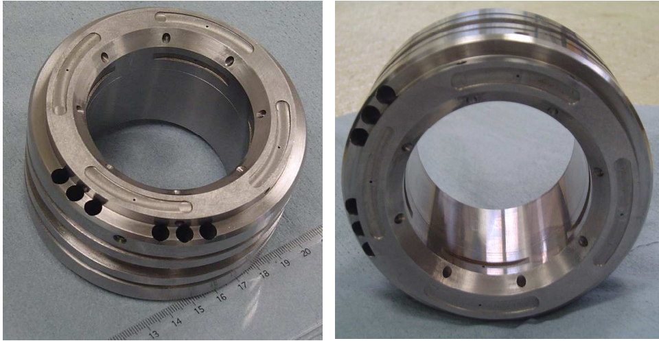
Figure IV.9 : Géométrie retenue pour le palier avant de la broche
