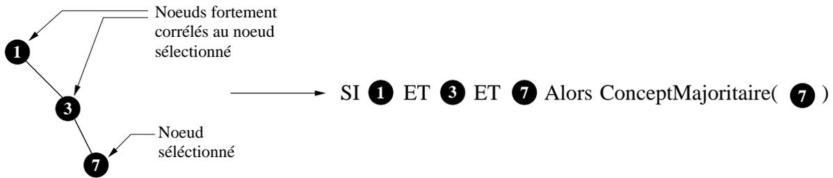
FIG. 6.2 – Passage d'une branche à une règle de classification.
