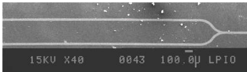
FIG. 4.21 – Image MEB d'une structure Mach-Zehnder de largeur 30\ \mu\text{m} gravée dans une couche de PZT de 0,8\ \mu\text{m} d'épaisseur
