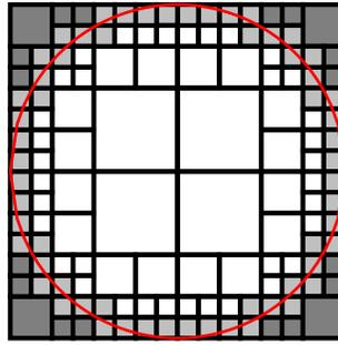
FIG. 3.8 – Décomposition en  $2^k$ -arbre de la contrainte  $x^2 + y^2 \leq 1$ , avec  $\mathbf{x} = \mathbf{y} = [-1, 1]$  : les pavés Inner sont représentées en blanc, les zones Outer en gris foncé et les zone Union en gris clair.
