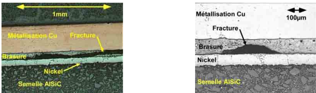
a) Fissure de la brasure semelle – DCB (vue longitudinale) b) Fissure de la brasure semelle – DCB (vue transversale)
