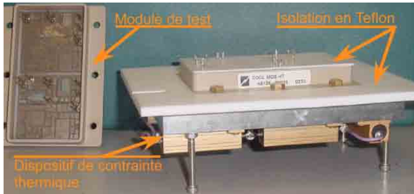
Figure II.23 : Banc de contrainte thermique des modules APT.
