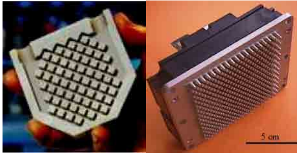
Céramique AlN [HAMI04] Semelle AlSiC [LEFR01] a) Solution de refroidissement par boîte à eau
