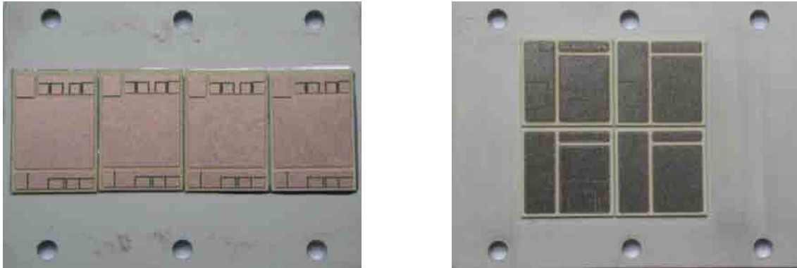
a) VT01 : DCB \text{Al}_2\text{O}_3 0,38mm ; Cu 300 \mu Sans dimples.
