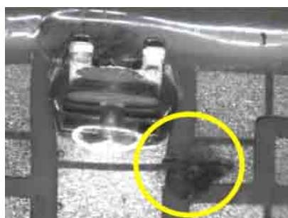
a) Décollement de la métallisation après 100 cycles.
