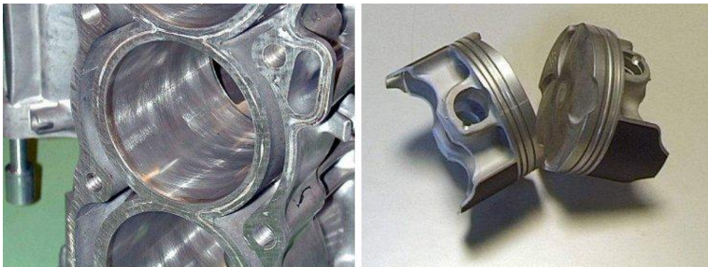
FIG. 5.55 – Equipage mobile piston/chemise. La chemise est strillée pour retenir des gouttelettes de lubrifiant. La jupe du piston est revêtue d'un matériau anti-friction.
