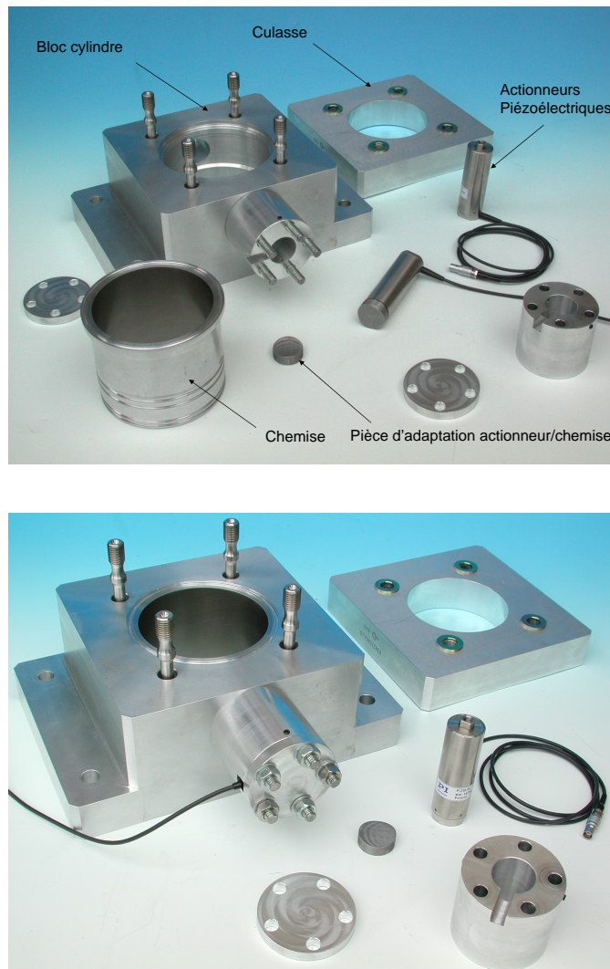
FIG. 5.63 – Photographie du bloc cylindre modifié. Photographie D. Harribey GREM 3
