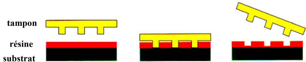
Figure 4 : Schéma des étapes de transfert du motif par nano-impression. Un tampon est pressé contre un substrat couvert de résine. Les motifs du tampon sont transférés sur la résine et peuvent être transférés sur l'échantillon par la suite [1].
