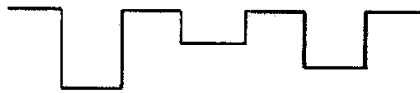
Figure 6 : Forme des puits de potentiel dans la transition d'Anderson. Le réseau garde la périodicité mais les puits ont des profondeurs variables.
