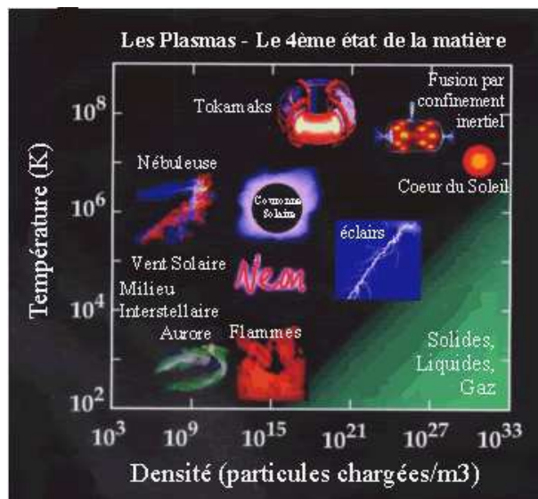
FIG. II.1 – Classement des plasmas spatiaux et terrestres en fonction de la densité et de la température
