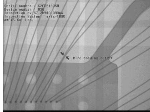
FIG. 1.10 – Inspection aux rayons X d'un composé électronique. Déformation des fils de connections (wire-sweep). Source : AMFIS
