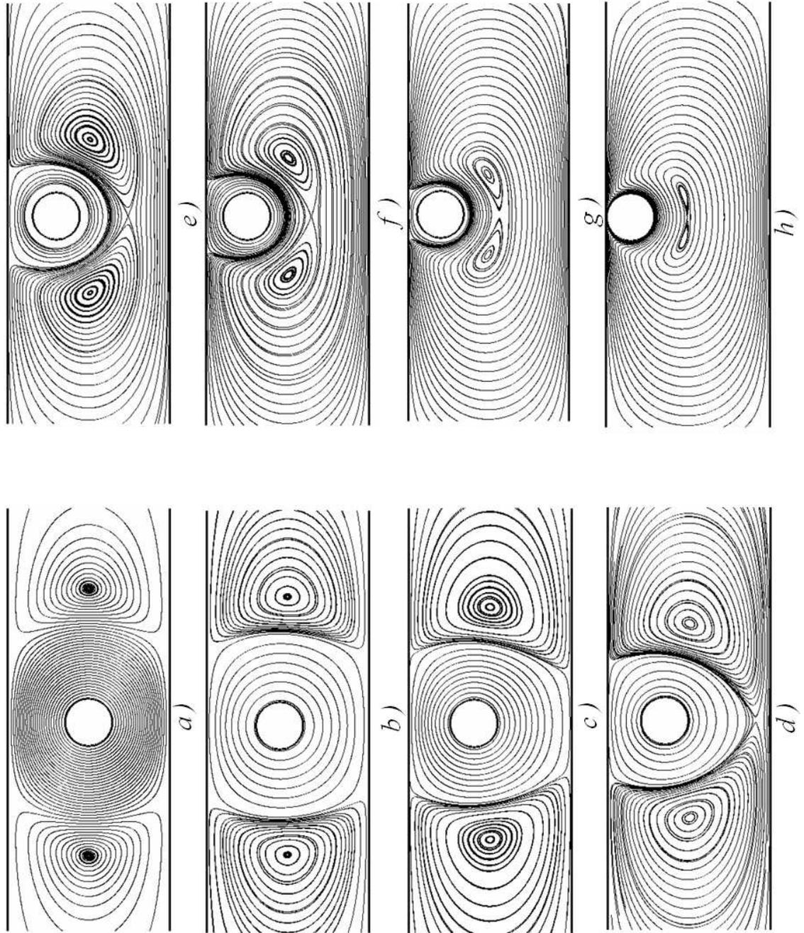
FIG. 4.33 – Lignes de courant autour d'un cylindre excentré en rotation pour  $e/e_{max} = :$
