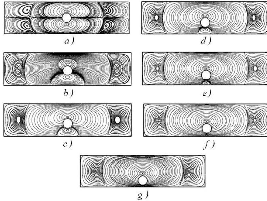
FIG. 4.16 – Lignes de courant autour du cylindre en translation uniforme dans un repère fixe pour  $k = 0.29$  et  $Re = 0.1$  avec  $e/e_{max} =$  : a) 0 - b) 0.141 - c) 0.282 - d) 0.423 - e) 0.563 - f) 0.704 - g) 0.845
