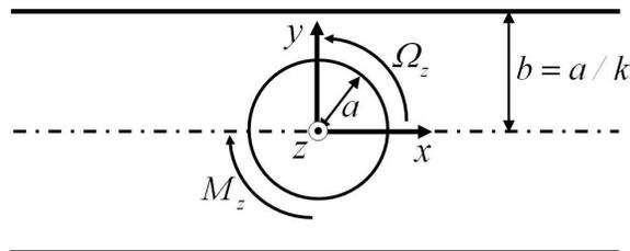
FIG. 3.18 – Schéma du problème du cylindre en rotation
