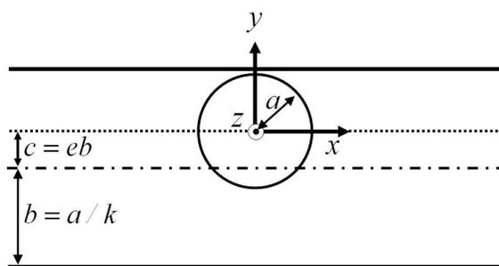
FIG. 4.1 – Schéma du problème du cylindre excentré
