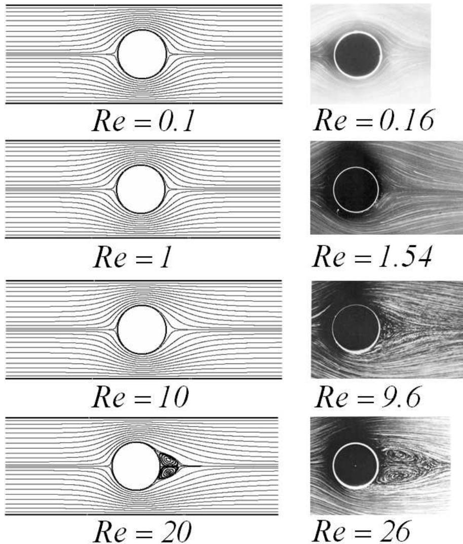
FIG. 3.4 – Lignes de courant. A gauche : autour d'un cylindre centré de confinement  $k = 0.5$  pour  $0.1 < Re < 20$ . A droite : autour d'un cylindre en milieu infini pour  $0.16 < Re < 26$ . Source : Van Dyke [7]
