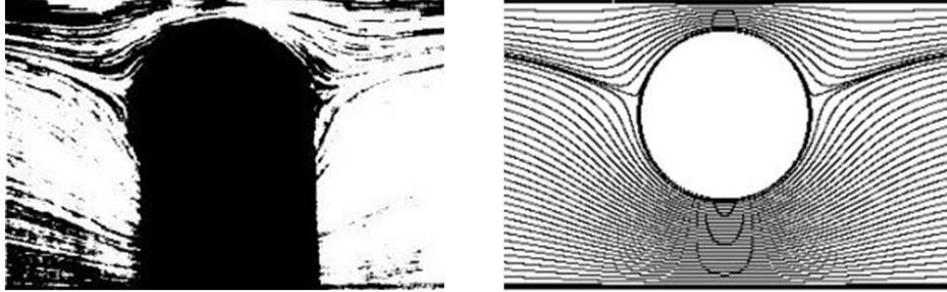
FIG. 4.31 – Lignes de courant autour d'un cylindre en écoulement de Poiseuille pour  $k = 0.6$ ,  $e/e_{max} = 0.5$  et  $Re \ll 1$ . A gauche : dans le travail de Dahir et al. [88] - A droite : dans nos calculs numériques
