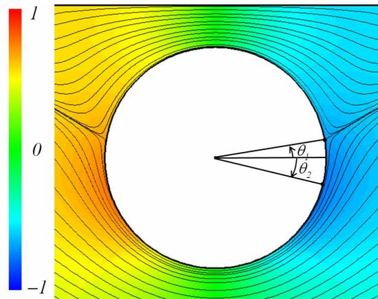
FIG. 4.26 – Lignes de courant et champ de pression autour d'un cylindre en écoulement de Poiseuille pour  $e/e_{max} \approx 0.85$ . La pression est normalisée par sa valeur maximale. A l'aval, le point d'arrêt se situe à  $\theta_1 \approx 9^\circ$  et l'extremum de pression à  $\theta_2 \approx -18^\circ$
