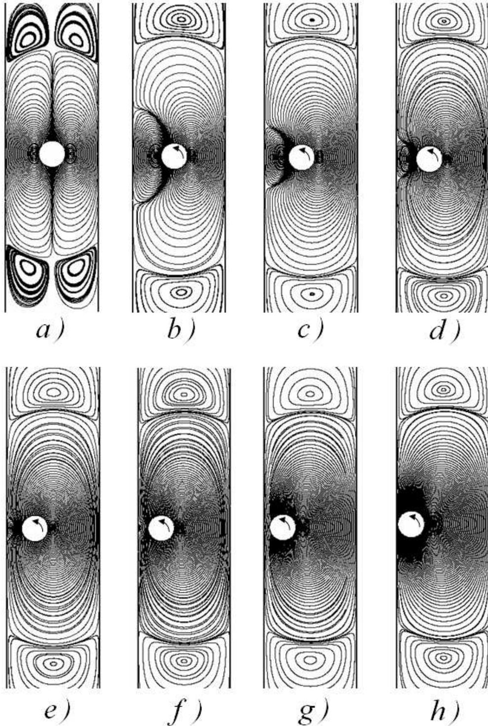
FIG. 5.13 – Lignes de courant autour d'un cylindre libre en sédimentation pour  $k = 0.29$  dans un référentiel lié aux plans pour  $e/e_{max} =$  : a) 0 - b) 0.141 - c) 0.282 - d) 0.423 - e) 0.563 - f) 0.704 - g) 0.845 - h) 0.986. L'accélération de la pesanteur est verticale descendante et le cylindre se déplace vers le bas
