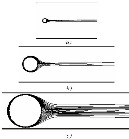
FIG. 2.6 – Isothermes autour du cylindre pour  $Pe = 1000$  et  $k = : a)0.1 - b)0.3 - c)0.9$  (conditions aux limites de type Dirichlet)
