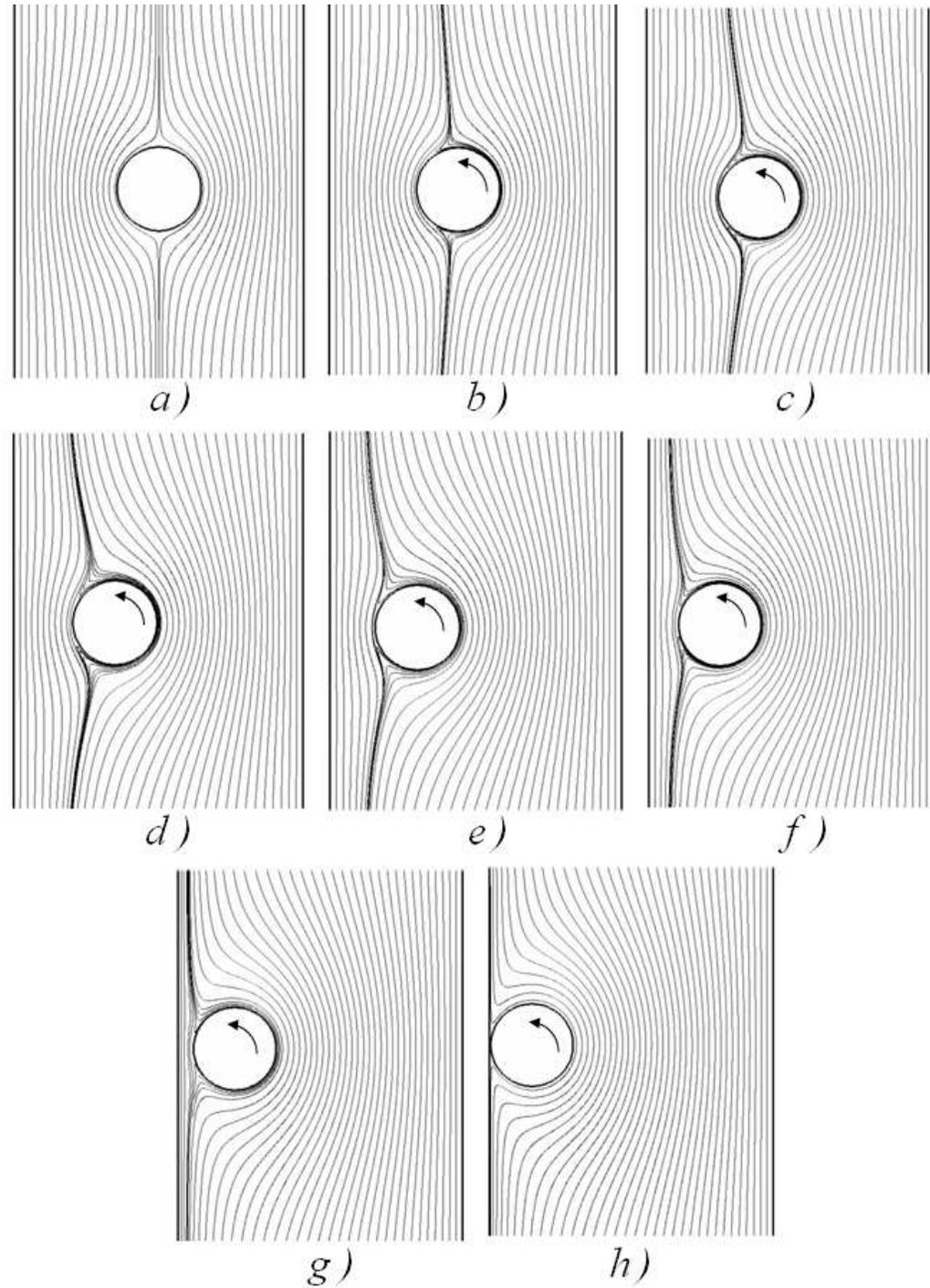
FIG. 5.12 – Lignes de courant autour d'un cylindre libre en sédimentation pour  $k = 0.29$  dans un référentiel lié au cylindre pour  $e/e_{max} =$  : a) 0 - b) 0.141 - c) 0.282 - d) 0.423 - e) 0.563 - f) 0.704 - g) 0.845 - h) 0.986. L'accélération de la pesanteur est verticale descendante et le cylindre se déplace vers le bas
