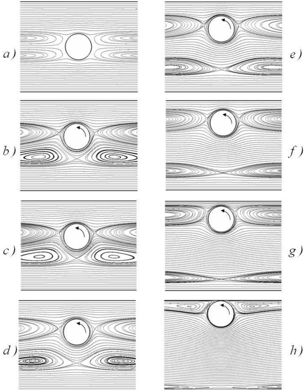
FIG. 5.17 – Lignes de courant autour d'un cylindre libre dans un écoulement de Poiseuille plan pour  $k = 0.29$  dans un référentiel lié au cylindre pour  $e/e_{max} =$  a) 0 - b) 0.141 - c) 0.282 - d) 0.423 - e) 0.563 - f) 0.704 - g) 0.845 - h) 0.986. Le fluide se déplace de la gauche vers la droite
