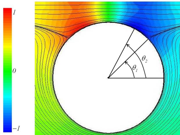
FIG. 4.7 – Lignes de courant et champ de pression autour d'un cylindre en translation uniforme pour  $e/e_{max} \approx 0.85$ . La pression est normalisée par sa valeur maximale. A l'amont, le point d'arrêt se situe à  $\theta_1 \approx 45^\circ$  et l'extremum de pression à  $\theta_2 \approx 61^\circ$
