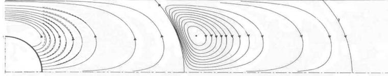
FIG. 4.17 – Lignes de courant autour du cylindre en translation uniforme dans un repère fixe pour  $k = 0.5$ ,  $e/e_{max} = 0$  et  $Re \ll 1$ . Source : Bourot et al. [57]
