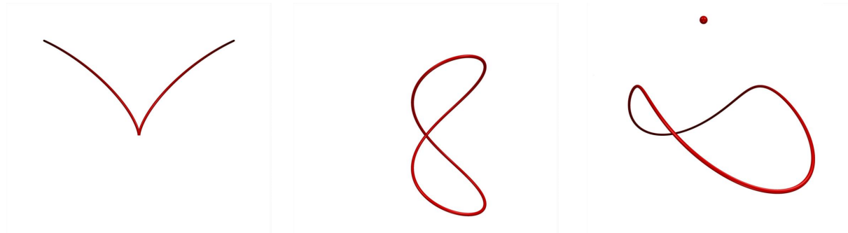
FIG. 6.1 – Les trois types de courbes singulières que nous pourrions rencontrer, à gauche une courbe ayant une singularité cuspidale, au centre une courbe ayant un nœud simple, et à droite une courbe ayant un point isolé.
