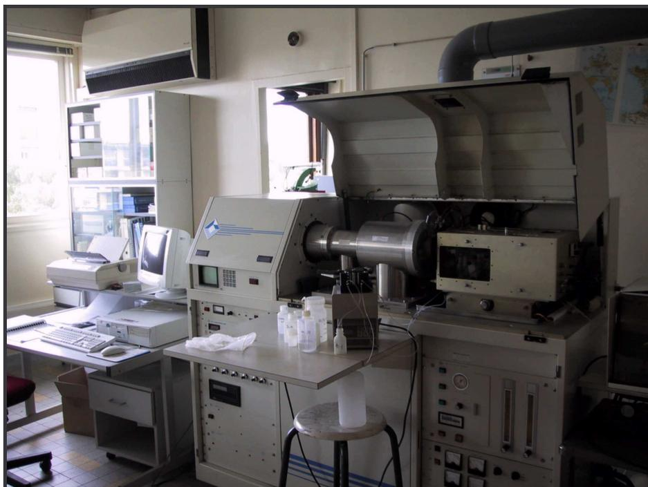
Nous avons essentiellement utilisé l'instrument VG PlasmaQuad de Montpellier (ISTEEM) et ponctuellement le VG X7 CCT de Lyon (ENS). L'ICP-MS est un spectromètre de masse quadripôle auquel est couplée une source à plasma d'argon : la torche plasma génère des cations tandis que le spectromètre de masse sélectionne et détecte les ions en fonction de leur masse.
