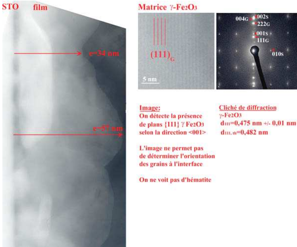
c) image MET et cliché de diffraction pour un film obtenu à T=600^{\circ}\text{C}
