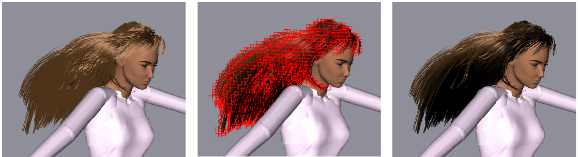
FIG. 4.1: Une chevelure animée rendue sans auto-ombrage (à gauche), et la même chevelure ombrée par notre algorithme (à droite). La structure 3D, orientée selon la direction de la lumière, qui stocke les valeurs de densité de la chevelure et de transmittance (au centre). La simulation totale de la chevelure (incluant l'animation et le rendu) est calculée en temps interactif sur un CPU standard.
