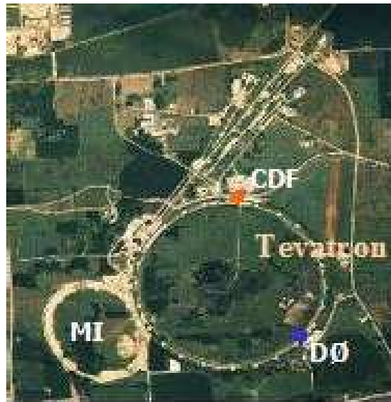
FIG. 2.1 – Vue aérienne du Tevatron et de l'emplacement des détecteurs CDF et DØ. Le Tevatron est l'anneau principal de la figure et il a un diamètre de 2 km.
