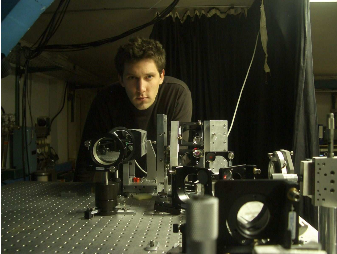
Figure V.3 — Alignement du montage optique au foyer coudé du télescope 152 de l'OHP. En premier plan, on voit la lentille du simulateur de télescope d'ATTILA alimenté ici par un faisceau laser à 633 nm, et juste devant moi, on aperçoit le bloc de filtres ainsi que le miroir sphérique de sortie (plus à gauche). La majeure partie du banc d'optique n'est pas utilisée et pourrait accueillir un système (simple) d'OA pour compenser les ordres élevés de la turbulence atmosphérique.
