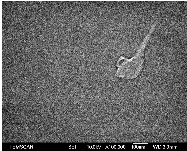
Fig. III.20. Zoom sur la surface l'échantillon Nd4M5-36 après recuit (image MEB-FEG en électrons secondaires). Aucune rugosité n'est visible. La granulosité de l'image vient du dépôt de métallisation au platine. L'impureté a été prise pour indiquer que la mise au point est bonne.
