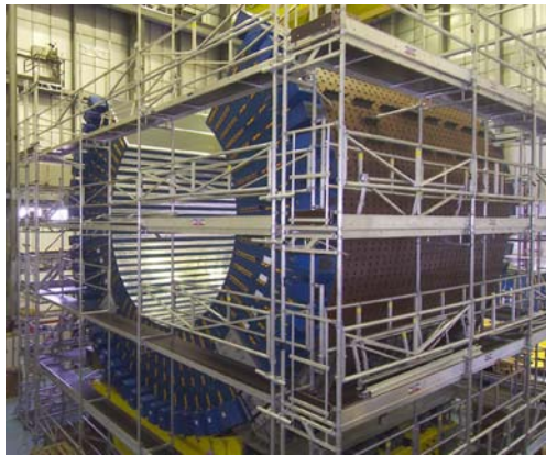
FIG. 2.19 – Calorimètre hadronique tonneau en cours de test d'assemblage au Cern.
