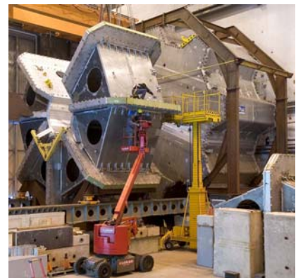
FIG. 2.32 – Vue de l'assemblage d'un toroïde bouchon.
