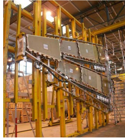
FIG. 2.29 – Assemblage d'un secteur d'une roue de la partie bouchon du spectromètre à muons.
