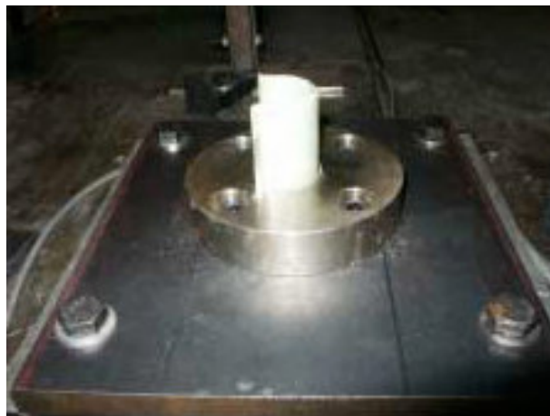
Figure B.1 : Système de fixation des éprouvettes.
