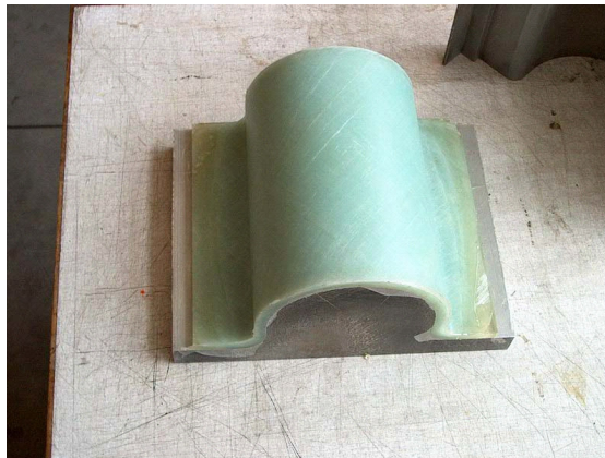
Figure A.3 : Eprouvette juste après le démoulage.
