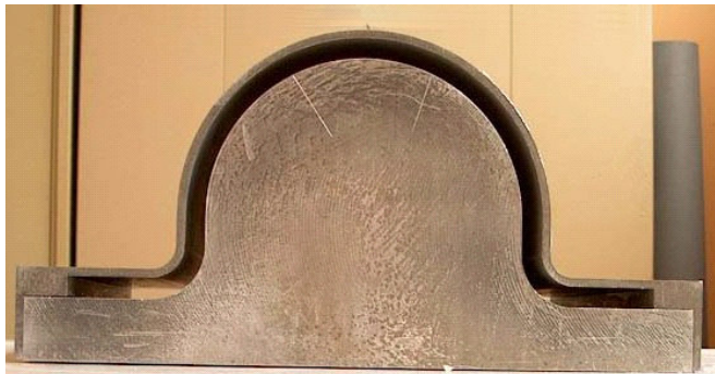
Figure A.1 : Moule et contre-moule utilisé pour la fabrication des éprouvettes.
