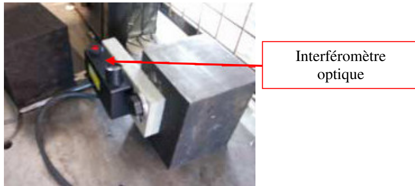
Figure B.2 : Capteur de Déplacement par interférométrie optique
