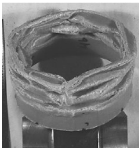
Figure 1.1 : Tube en Kevlar / époxy après essai de compression. (d'après Dubey & Vizzini [DUB 99])
