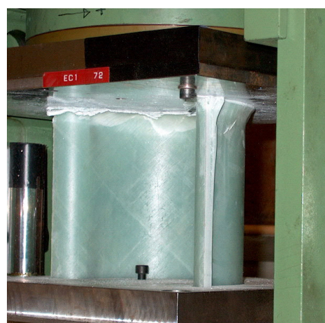
Figure 1.7.2 : Eprouvette à l'échelle 1 en cours d'essai.
