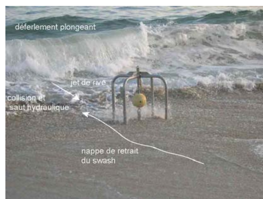
Illustration 93. Jet de rive et nappe de retrait dans la zone de swash à Tregana.
