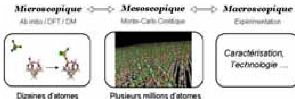
Figure I-5: Stratégie à multi-échelle de la modélisation de la croissance par ALD des films à forte permittivité.
