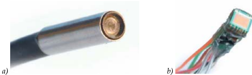
Figure 5-8 : a) le vidéo-endoscope. b) la matrice CCD du vidéo-endoscope.
