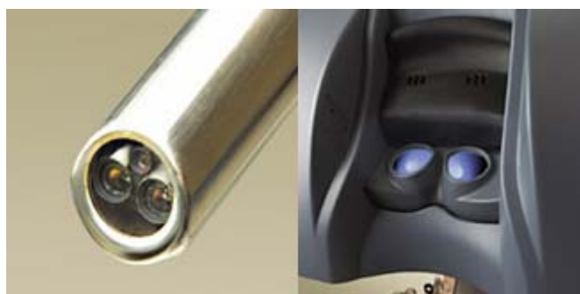
Figure 5-3 : Endoscope stéréoscopique du robot DA VINCI.
