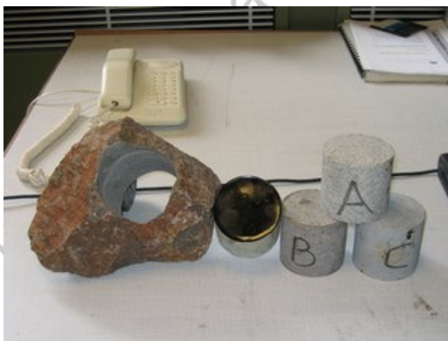
Fig. V- 8 : (a) Photo des éprouvettes des roches de granite (A), de rhyolite (B), de quartzite (C) et d' une éprouvette de bitume. A gauche, un échantillon d' une roche carottée.
