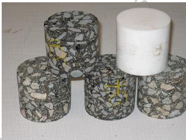
Fig. IV- 21 : Photo de quelques éprouvettes de bétons bitumineux et d'un échantillon de Téflon.
