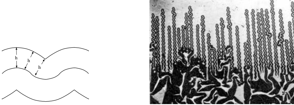
FIG. 2.5 – a Un mécanisme de génération de singularités lors de l’oscillation d’une structure. Une courbe et ses premières courbes parallèles singulières. b Un film comprimé sur un substrat rigide peut se décoller sur des zones qui ressemblent à des fils de téléphone – les singularités de la forme sont identiques à la partie (a) de la figure.
