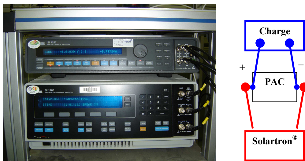
Figure V-9 : A gauche, Interface Electrochimique et Analyseur Solartron®. A droite, montage expérimental.
