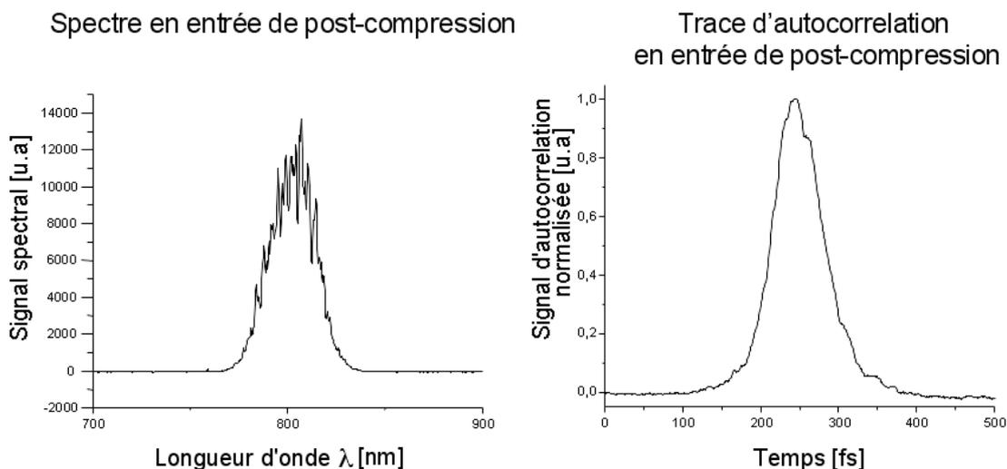
FIGURE I.14 : CONDITIONS INITIALES D'EXPÉRIENCE DE POST-COMPRESSION DANS L'ARGON. L'IMPULSION INJECTÉE À UNE DURÉE (FWHM) DE 39 fs.
