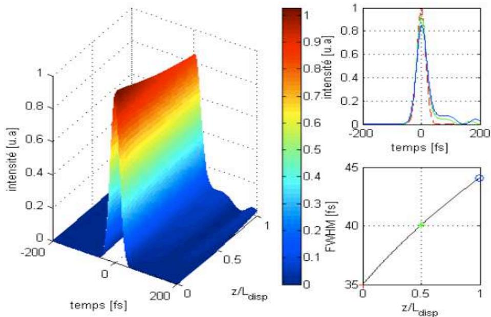
FIGURE 1.8 : ÉVOLUTION DU PROFIL TEMPOREL D'UNE IMPULSION GAUSSIENNE DE 35 fs DUE À LA DISPERSION D'ORDRE 2 ET 3 POUR UNE PRESSION D'ARGON DE 500 mbar.
