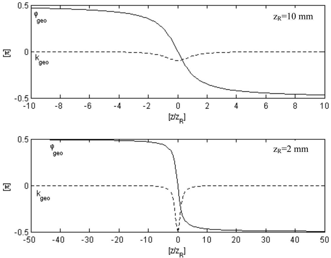
FIGURE 2.7: PHASE DE GOUY  $\phi_{\text{GOUY}}$  (LIGNE CONTINUE EXPRIMEE EN  $\pi$  RAD) D'UN FAISCEAU GAUSSIEN ET SA DÉRIVÉE PAR RAPPORT À  $z$  (LIGNE POINTILLE  $k_{\text{geo}}$  EXPRIME EN  $\text{mm}^{-1}$ ) EN FONCTION DE SA DISTANCE AU POINT FOCAL (FOYER EN  $z/z_R=0$ ).
