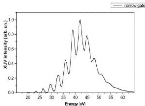
FIGURE 3.5 : SPECTRE VUV HARMONIQUE EN CONFIGURATION « PORTE ÉTROITE » POUR UNE IMPULSION GÉNÉRATRICE DE 10 FS, UNE PRESSION D'ARGON DE 40 MBAR ET UN ÉCLAIREMENT DE  $3,3 \cdot 10^{14}$  W/CM<sup>2</sup>.
