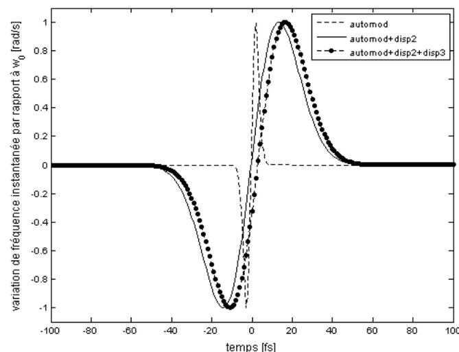
FIGURE I.10 : VARIATION DE LA FRÉQUENCE INSTANTANÉE D'UNE IMPULSION LASER INITIALEMENT DE 35 fs (PAR RAPPORT A  $\omega_0$  PRIS POUR ORIGINE) SUBISSANT L'EFFET DE L'AUTOMODULATION DE PHASE SEULE (TIRETS), LES EFFETS COMBINÉS DE L'AUTOMODULATION DE PHASE ET DE LA DISPERSION D'ORDRE 2 (CONTINU) ET LES EFFETS COMBINÉS DE L'AUTOMODULATION DE PHASE ET DES DISPERSIONS D'ORDRE 2 ET 3 (POINT), POUR UNE PHASE NON LINEAIRE MAXIMALE DE  $4.5 \pi$ .
