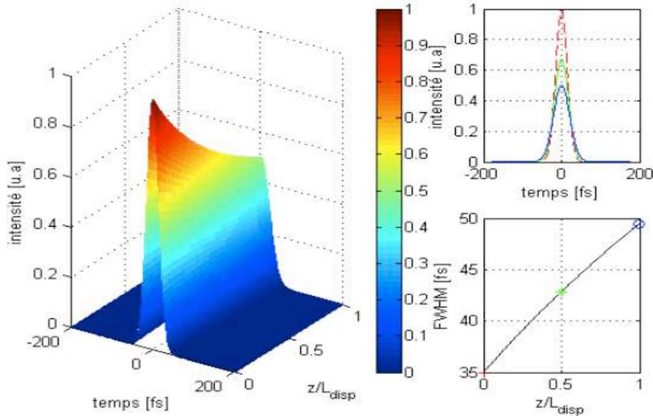
FIGURE 1.7 : ÉLARGISSEMENT TEMPOREL D'UN IMPULSION GAUSSIENNE DE 35 fs DUE À LA DISPERSION DE VITESSE DE GROUPE POUR UNE PRESSION D'ARGON DE 500 mbar ( $\beta_2 \sim 6,28 \text{ fs}^2/\text{m}$ ).
