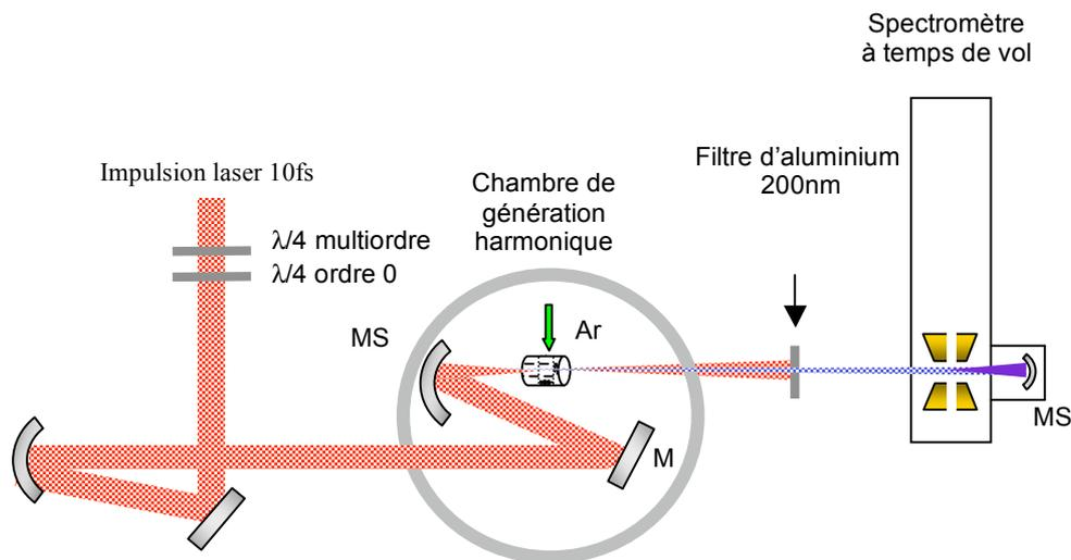
FIGURE 2.1 : DISPOSITIF EXPÉRIMENTAL POUR L'ETUDE DE L'INFLUENCE SUR LE SPECTRE HARMONIQUE DE LA PORTE D'ELLIPTICITÉ.
