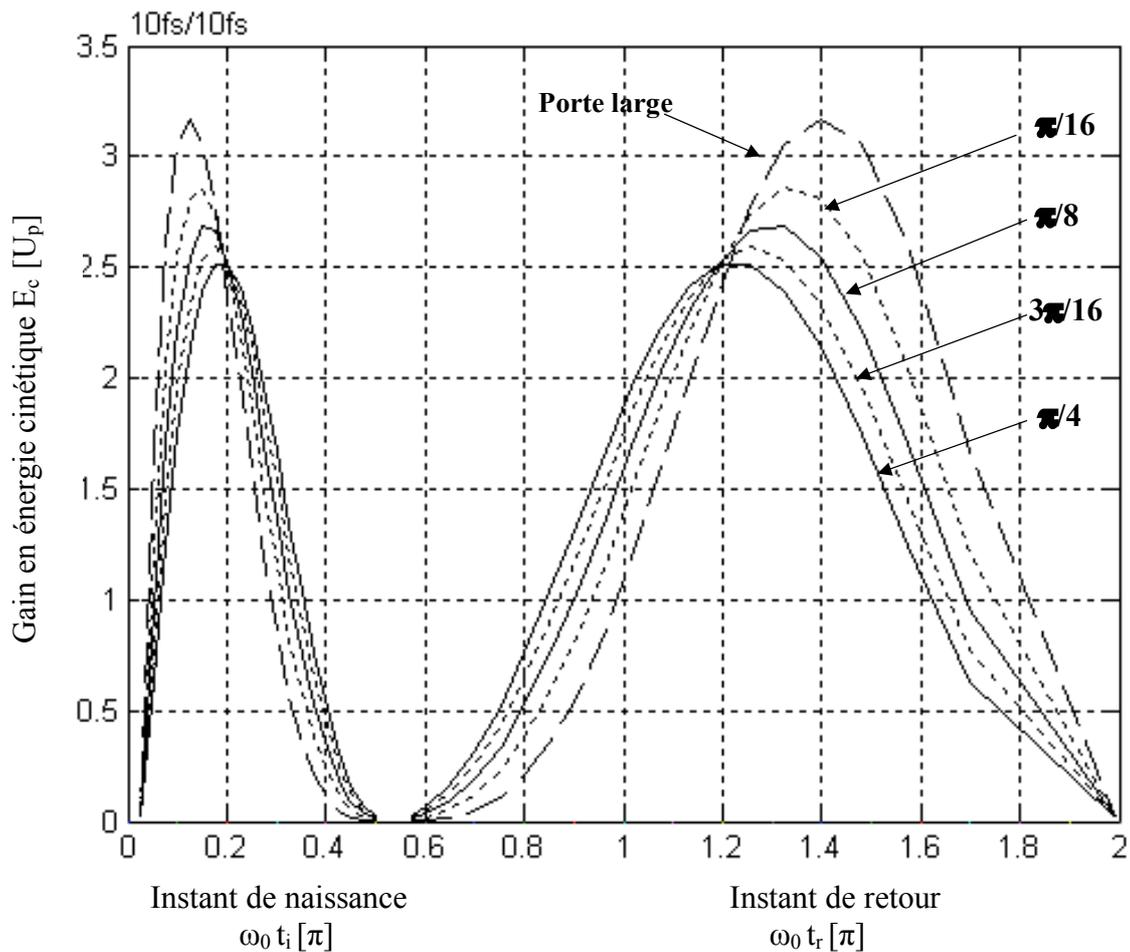
FIGURE(1.16) : GAIN EN ENERGIE CINÉTIQUE (EN UNITÉ  $U_p$ ) DE L'ELECTRON EN FONCTION DE LA PHASE ABSOLUE LASER .L'IMPULSION LASER A UNE DURÉE DE 10 fs ET LA PORTE D'ELLIPTICITÉ EST CRÉÉE POUR UN DÉLAI  $\delta\tau=10$  fs.
