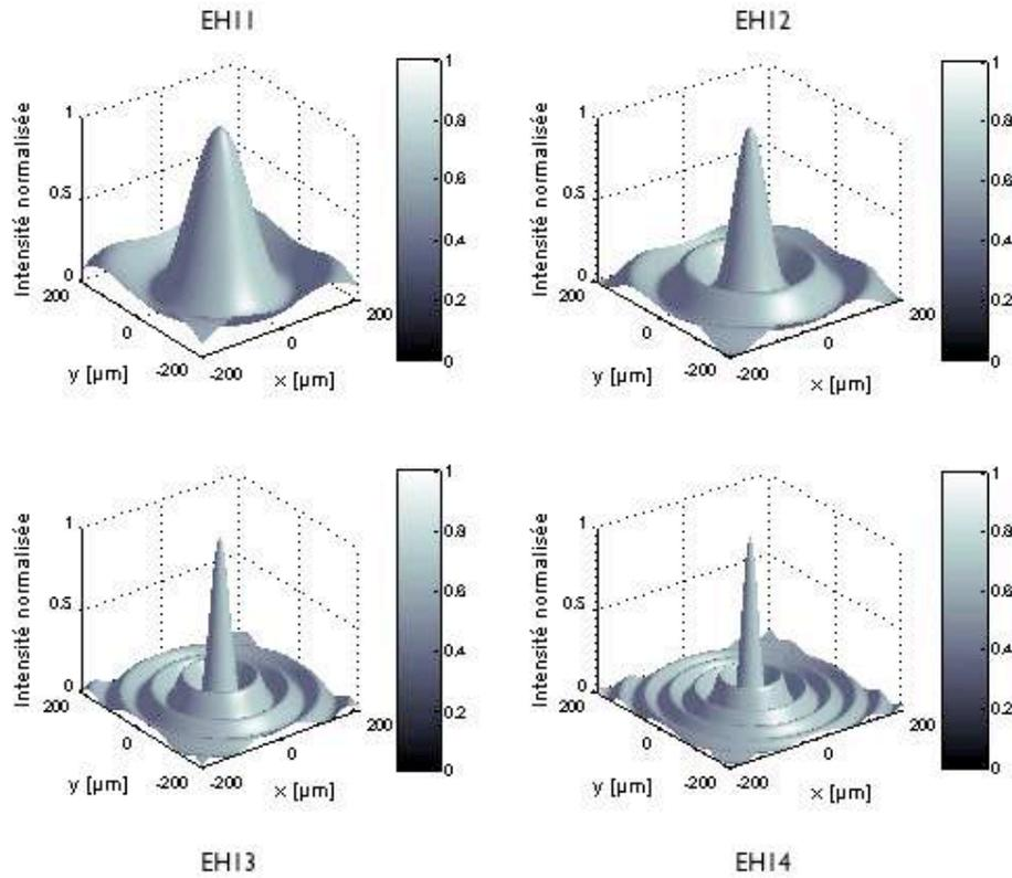
FIGURE 1.3: PROFILS TRANSVERSES DES MODES EH<sub>1n</sub> (N ∈ { 1 ; 2 ; 3 ; 4 }) DE PROPAGATION DANS UNE FIBRE CREUSE (EN SILICE SF n(SF)=1.45843) DE RAYON INTERNE A=170μm.
