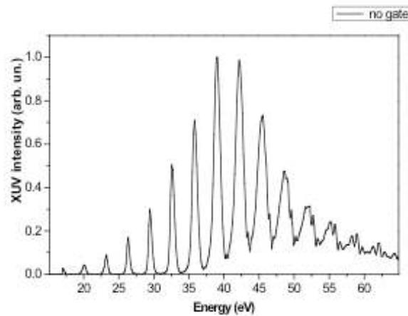
FIGURE 3.4 : SPECTRE VUV HARMONIQUE EN CONFIGURATION « SANS PORTE » POUR UNE IMPULSION GÉNÉRATRICE DE 10 FS, UNE PRESSION D'ARGON DE 40 MBAR ET UN ÉCLAIREMENT DE  $1,6 \cdot 10^{15}$  W/CM<sup>2</sup>.
