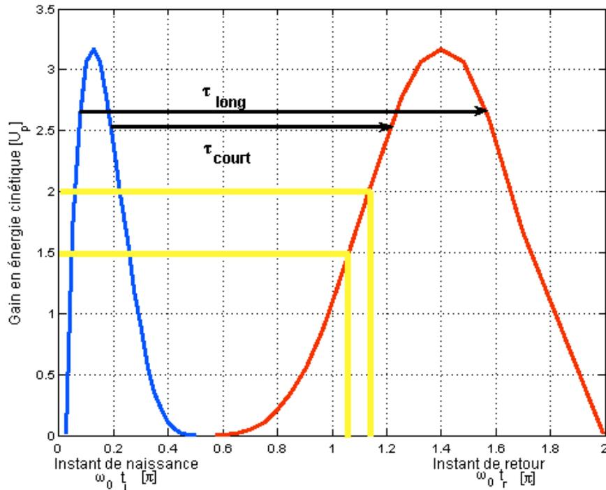
FIGURE 2.6: ÉNERGIES CINÉTIQUES ACQUISES PAR L'ÉLECTRON A L'INSTANT DE RETOUR EN FONCTION DES PHASES DE NAISSANCES  $\omega_0 t_i$  (BLEU) DE L'ELECTRON DANS LE CONTINUUM ET DE CES PHASES DE RETOUR  $\omega_0 t_r$  (ROUGE) A L'ION PARENT.
