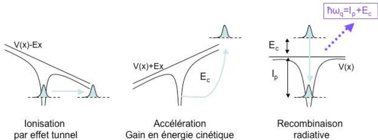
FIGURE 2.2 : MODÈLE SEMI-CLASSIQUE EN 3 ÉTAPES : IONISATION PAR EFFET TUNNEL, ACCÉLÉRATION DU PAQUET D'ONDE ELECTRONIQUE LIBRE PAR LE CHAMP LASER ET RECOMBINAISON RADIATIVE DE CE PAQUET D'ONDE ELECTRONIQUE.
