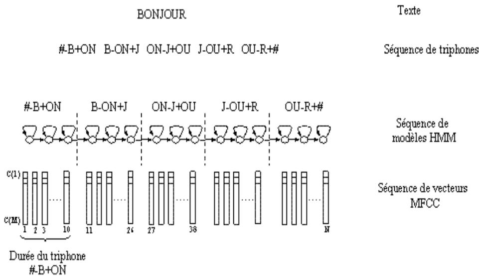
Figure 3.7 – Exemple de génération d'une cible acoustique.
