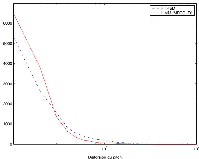
Figure 4.8 – Différences de fréquence fondamentale calculées aux points de concaténation pour les deux méthodes FTR&D et HMM\_MFCC\_ $F_0$  avec présélection.
