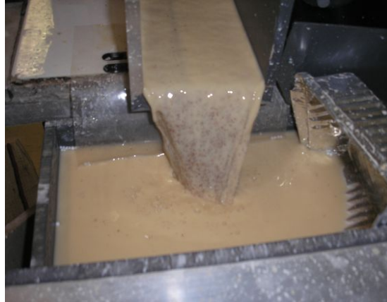
FIG. 5.20: Deux modes de transport en interaction : le charriage des grains de brique pilée et la suspension de kaolinite : S = 4\% , Q = 10 \text{ L min}^{-1} , C_{susp} = 12 \text{ g L}^{-1} , Q_s \approx 6 \text{ g s}^{-1} , Rouse = 0.99 et Re = 6800
