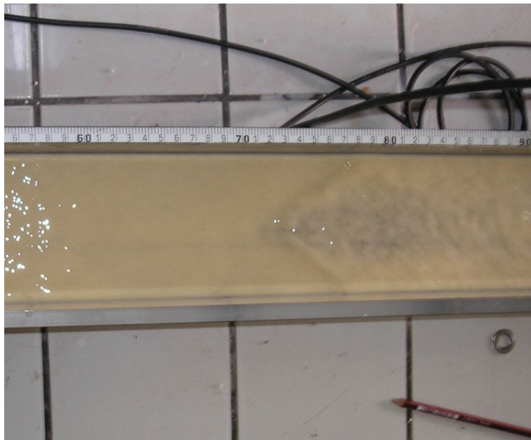
FIG. 5.2: Ressaut hydraulique provoqué par le dépôt de brique pilée
