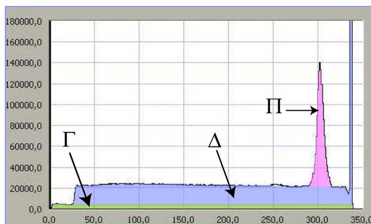
FIG. 7.1 – Spectre TDC du PMT-filtre à basse énergie. La partie  $\Pi$  est le signal proprement dit. La partie  $\Delta$  est le plateau de fortuites. La partie  $\Gamma$  est le plateau d'événements fortuits (voir texte).
