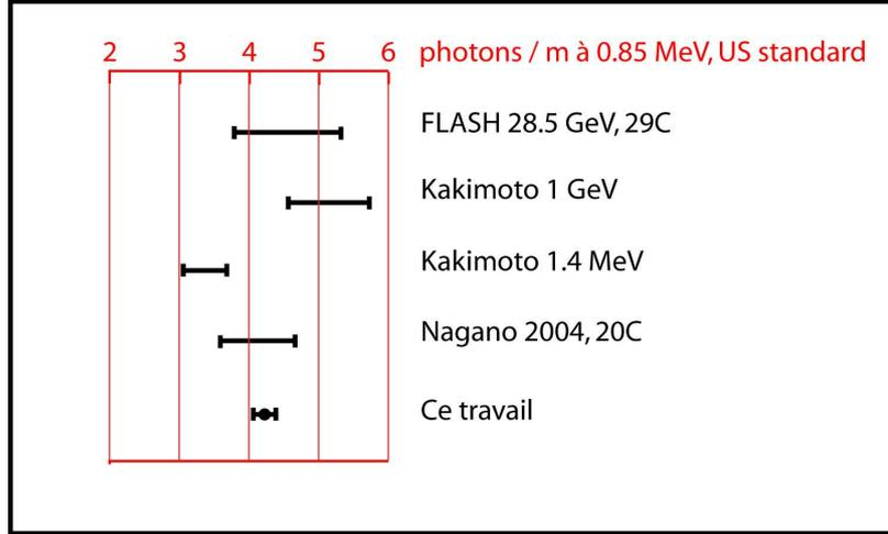
FIG. 7.4 – Comparaison des résultats des mesures de rendements de fluorescence à 0.85 MeV et dans les conditions de l’atmosphère US Standard. Le résultat de [NAGANO<sup>+</sup>04] est pris entre 300 et 430 nm, il est donc directement comparable à notre valeur.
