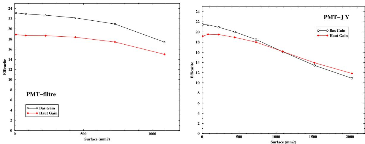
FIG. C.12 – Variation de l'efficacité du PMT-filtre (à droite) et du PMT-JY (à gauche), en fonction de la surface détectrice effective.
