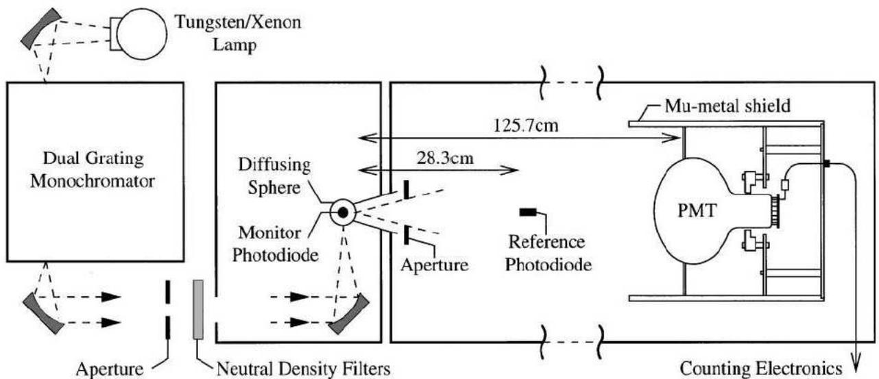
FIG. 6.2 – Montage créant une source contrôlée pour la calibration d'un PMT [BILLER<sup>+</sup>99].
