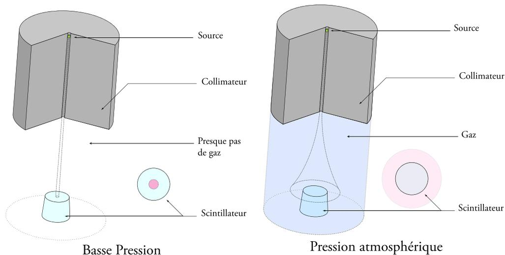
FIG. 4.4 – Dans le vide (schéma de gauche), le faisceau parallèle d'électrons est correctement collimaté par le cylindre de plomb. Le taux de comptage est donc maximum. Par contre, à pression atmosphérique, la diffusion des électrons dans le gaz élargit le faisceau et diminue la fréquence de détection des électrons.
