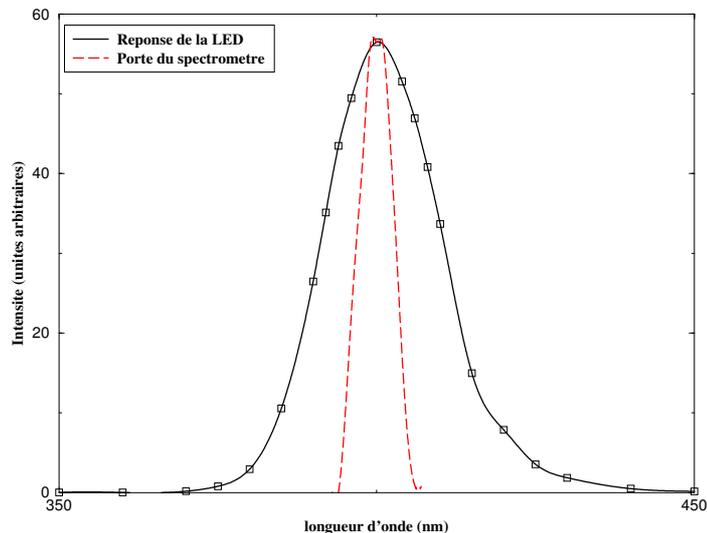
FIG. 5.3 – Largeurs comparées de la LED et de la réponse du spectromètre. En noir, la réponse de la LED de 400 nm. En rouge, la réponse propre du spectromètre : c'est la courbe de la figure 5.6 pour des fentes de 2 mm, translattée à 400 nm.
