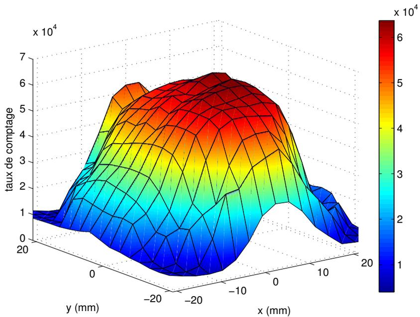
FIG. 6.13 – Réponse du PMT-JY vue en trois dimensions et à haut gain, normalisée à la puissance lumineuse reçue par la photodiode.
