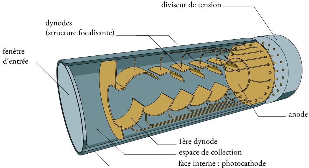
FIG. 6.1 – Représentation schématique d'un tube photomultiplicateur.
