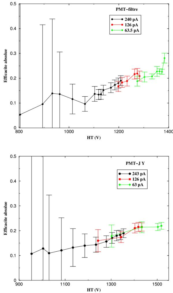
FIG. C.9 – Variation de l'efficacité de chaque PMT en fonction de la haute tension appliquée.
