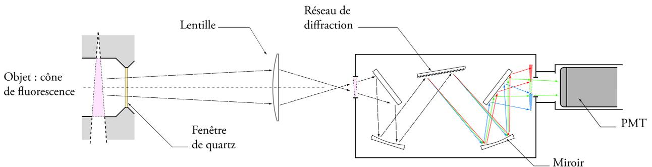
FIG. 4.9 – Représentation schématique de l’optique du montage.
