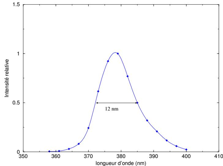
FIG. 6.4 – Spectre d'intensité relative de la LED RLT370-10 utilisée pour la calibration, mesuré avec le spectromètre. Les fentes d'entrée et de sortie sont ouvertes à 2 mm et contribuent pour 6 nm à la largeur observée. La largeur réelle de la LED est donc de 10 nm.
