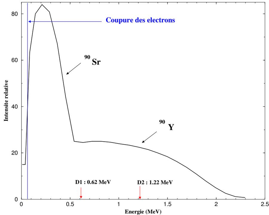
FIG. 4.2 – Spectre  $\beta$  du strontium et de l'yttrium. L'énergie maximale est 2.28 MeV. (référence : [HANSEN<sup>+</sup>83])
