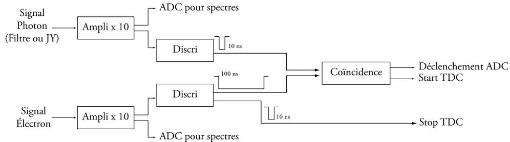
FIG. 4.17 – Schéma simplifié de l'acquisition de données. Le schéma complet, incluant les retards, se trouve en annexe. Le signal électron a une largeur de 100 ns à l'entrée de la coïncidence pour tenir compte des durées de vie des niveaux moléculaires : le signal photon est naturellement retardé. En revanche, l'arrêt du TDC est commandé par un signal court pour éviter d'inclure un temps mort supplémentaire.
