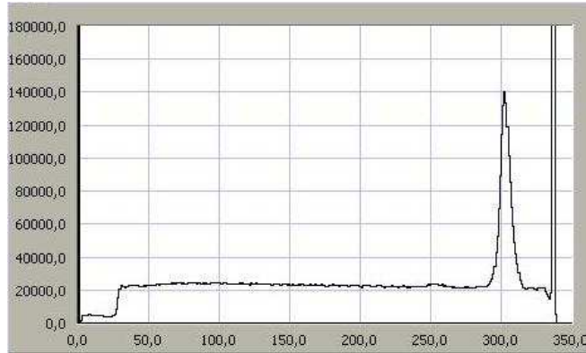
FIG. 4.3 – Exemple de spectre TDC inversé (voir texte) de l'intégrale de la fluorescence (de 300 à 430 nm). La partie triangulaire est le signal proprement dit : la décroissance exponentielle de la désexcitation des molécules d'azote. La partie plate correspond aux coïncidences fortuites entre les électrons et les photoélectrons émis par la photocathode sans qu'un photon de fluorescence lui soit parvenue. L'échelle verticale est le nombre d'évènements, et l'échelle horizontale est le canal du TDC.
