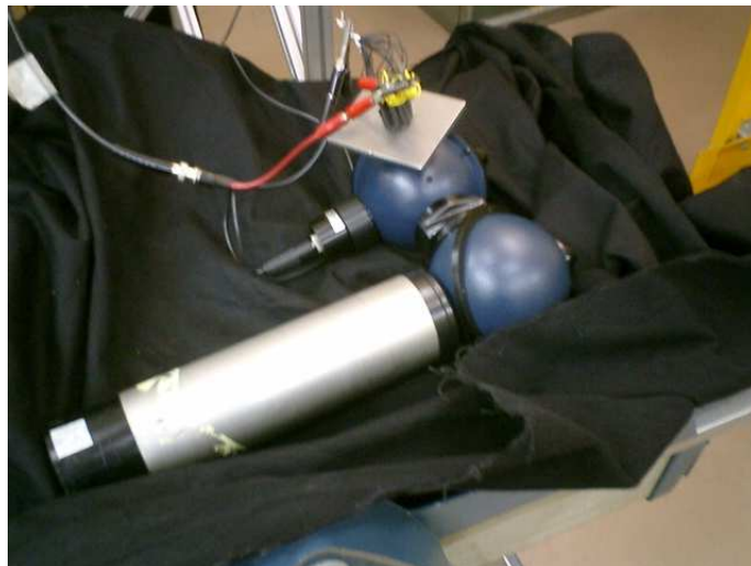
FIG. D.5 – Calibration absolue d'un PMT. La source de lumière (matrice de 19 LED à 400 nm) est fixée au-dessus de la première sphère. Une des sorties de cette sphère envoie le flux sur une photodiode calibrée Ophir (en noir). Un diaphragme limite l'émission de l'autre sortie, afin que peu de lumière parvienne dans la seconde sphère et au PMT.
