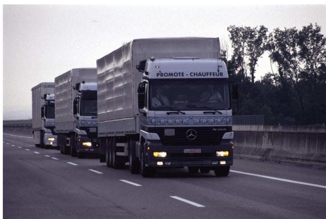
*Figure 1-4 : Suivi de véhicules poids lourds (projet CHAUFFEUR soutenu par ADASE) /CHAUF/*
