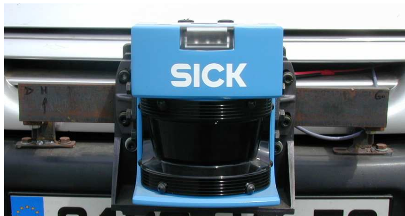
Figure 4-6 : Capteur à balayage laser LMS200 de la société SICK
