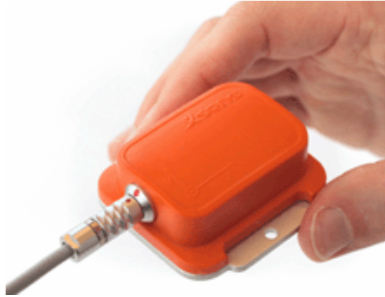
Figure 4-3 : Centrale inertielle de la société Xsens /Xsens/
