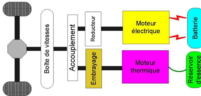
Figure 4-2 : Architecture mécanique du véhicule hybride /Delprat 2002/
