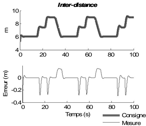
Figure 4-22 : Consigne d'inter-distance et inter-distance
