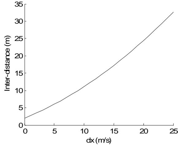
Figure 4-18 : Inter-distance en fonction de la vitesse
