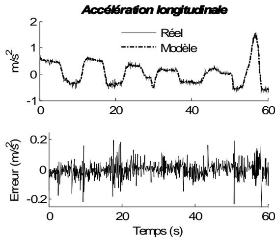
Figure 4-10 : Estimation : accélérations longitudinales mesurée et simulée
