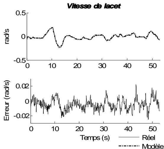
Figure 4-16 : Validation : vitesse de lacet mesurée et simulée
