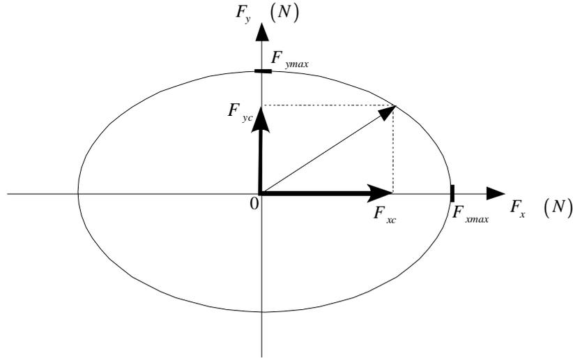
Figure 2-8 : Couplage des forces longitudinale et latérale
