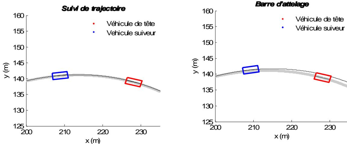
Figure p-7 : Parcours des véhicules lors d'un suivi de trajectoire et d'un suivi de type barre d'attelage
