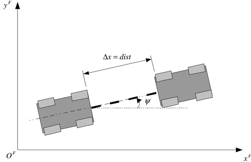
Figure 4-28 : Configuration des véhicules en Régime permanent
