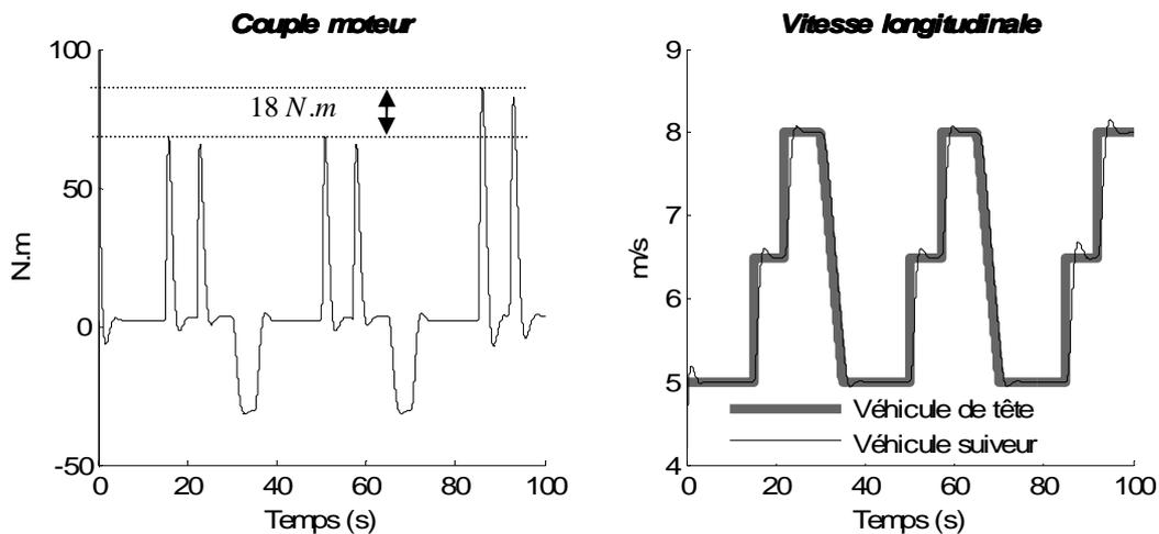
Figure 4-21 : Couple moteur du véhicule suiveur et vitesses des deux véhicules
