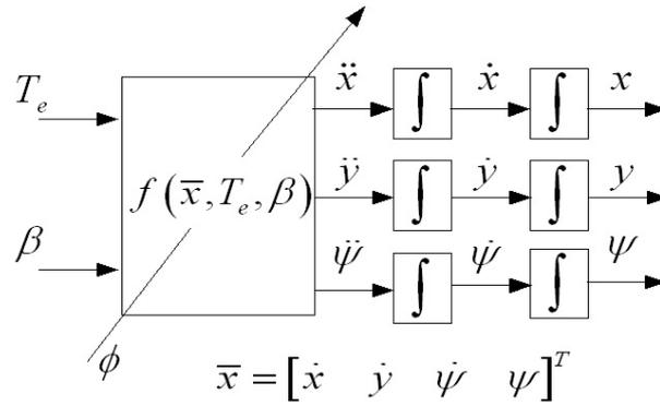
Figure 4-8 : Positions du véhicule obtenues par double intégration
