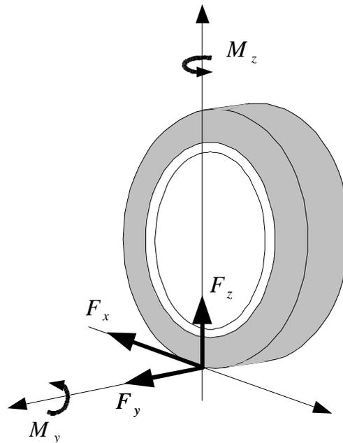
Figure 2-1: Forces et moments appliqués aux roues
