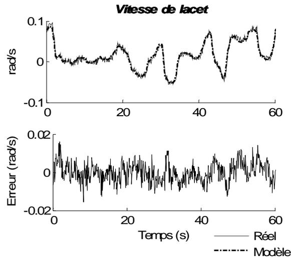
Figure 4-12 : Estimation : vitesse de lacet mesurée et simulée
