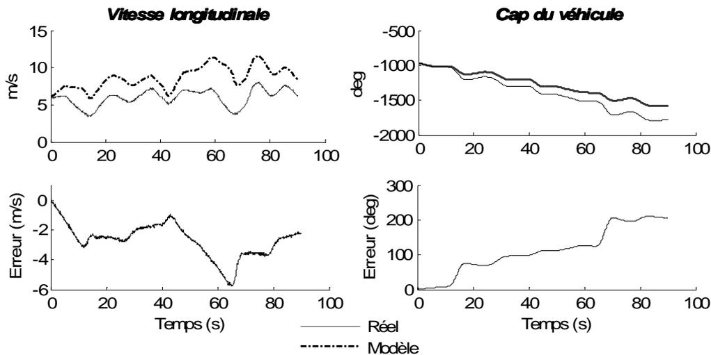
Figure 2-15 : Vitesse et cap mesurées et simulées
