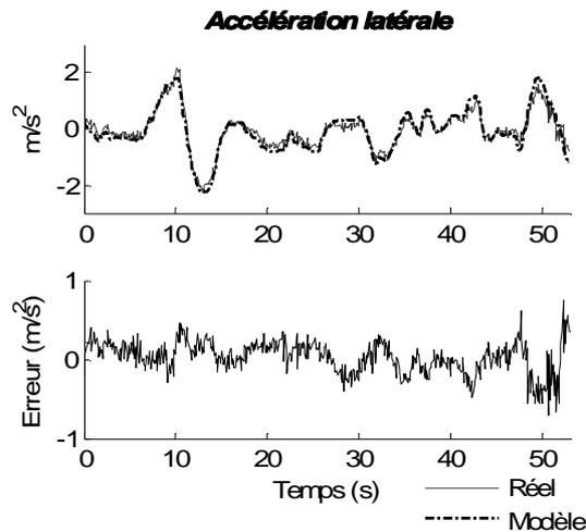
Figure 4-15 : Validation : accélérations latérales mesurée et simulée
