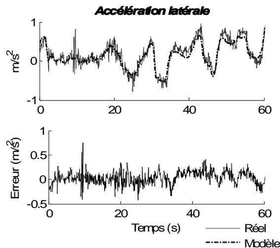
Figure 4-11 : Estimation : accélérations latérales mesurée et simulée
