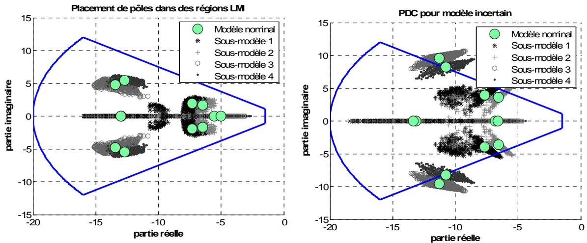
Figure 3-7 : Evolution des pôles des sous-modèles en fonction de variations des incertitudes
