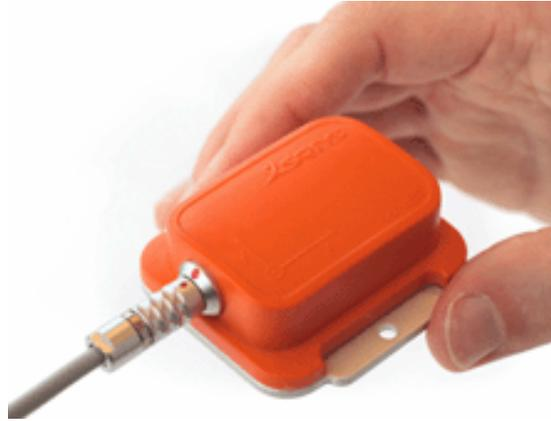
Figure 4-3 : Centrale inertielle de la société Xsens /Xsens/
