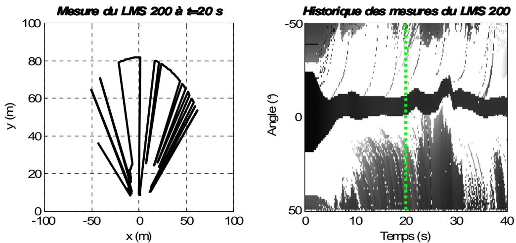
Figure 4-5 : Exemple de données renvoyées par le LMS 200
