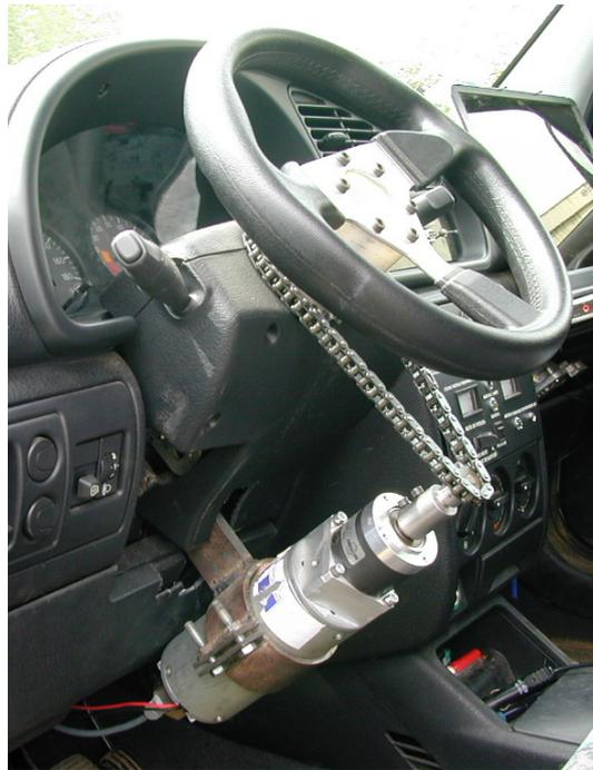
Figure 4-7 : Instrumentation de la colonne de direction
