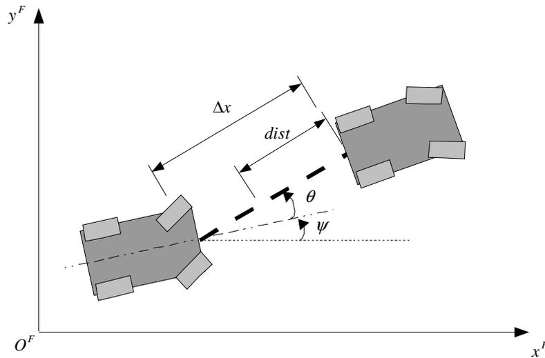
Figure 4-27 : Configuration de type barre d'attelage
