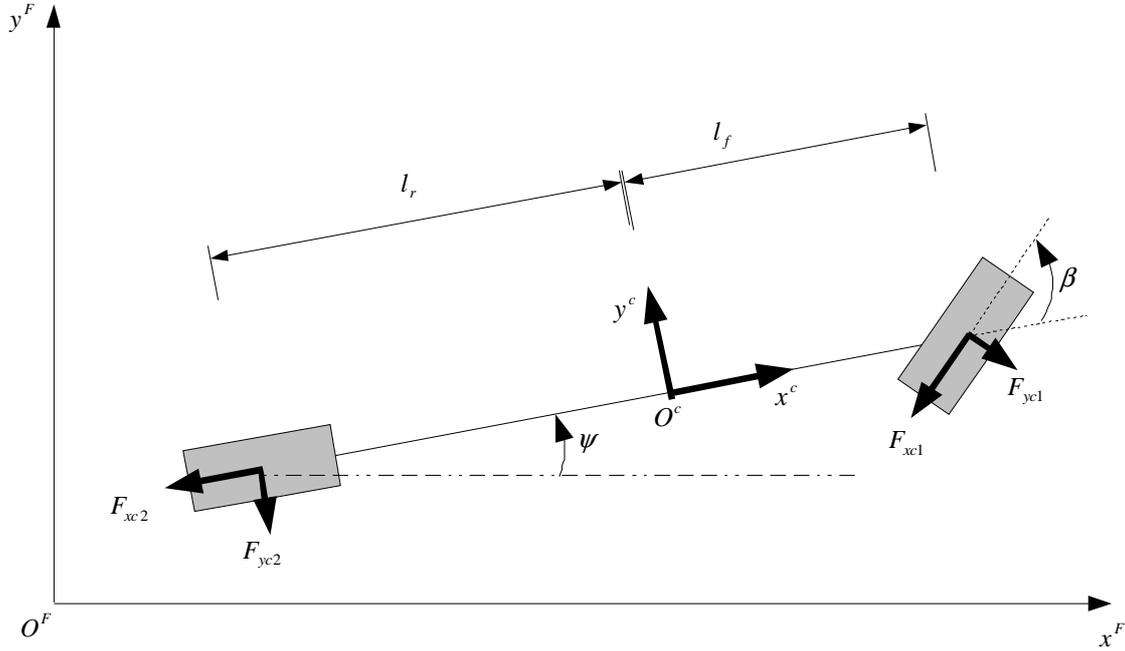
Figure 2-9 : Modèle « bicyclette » d'un véhicule
