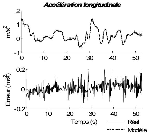
Figure 4-14 : Validation : accélérations longitudinales mesurée et simulée
