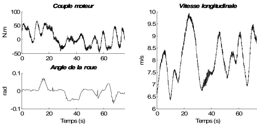
Figure 4-38 : Commandes et vitesse du véhicule suiveur lors de l'expérimentation
